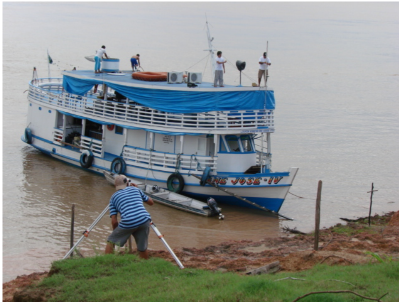
Figura 6.10- Nivelamento de antenas GPS sobre o barco.
