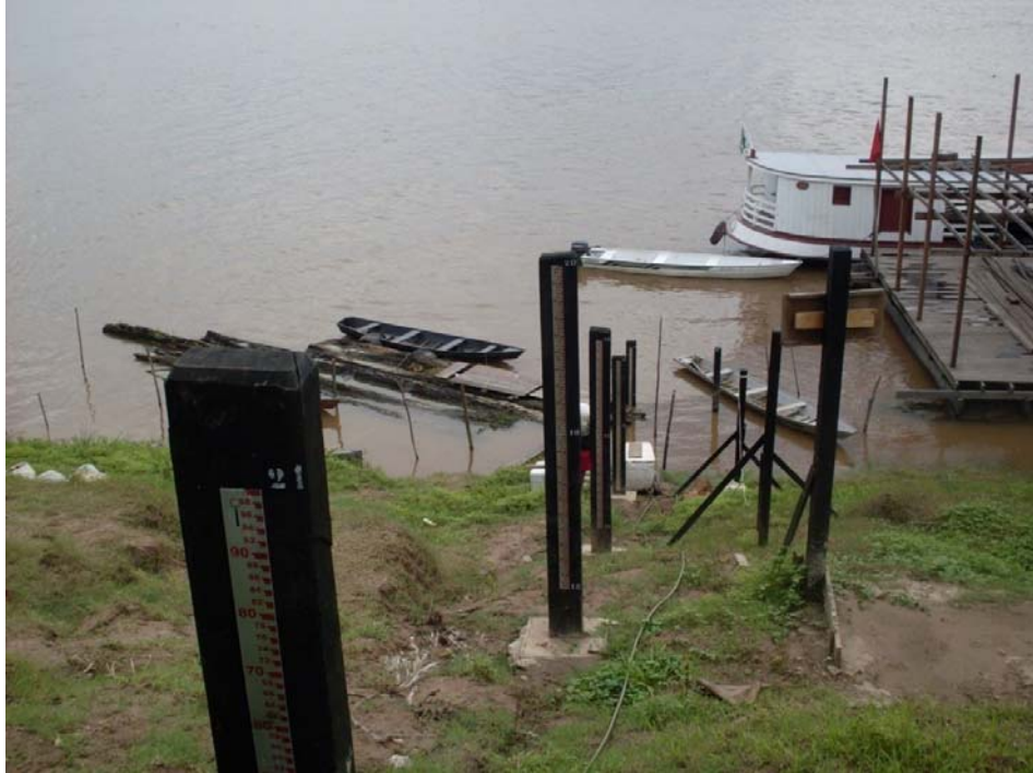
Figura 6.3- Exemplo de estação fluviométrica e seus lances de régua.
