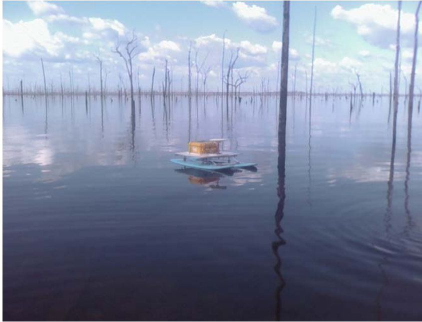
Figura 7.32- Lago de Balbina e os diversos troncos de árvores, o que dificultou o levantamento e o processamento de dados GPS obtidos pela prancha flutuante.
