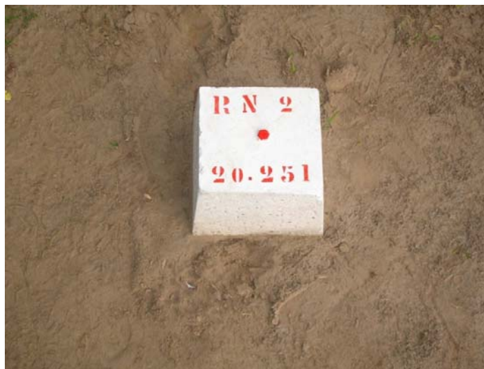
Figura 6.5- Referência de nível (RN) utilizada para nivelamento das réguas limimétricas, com referência arbitrária.
