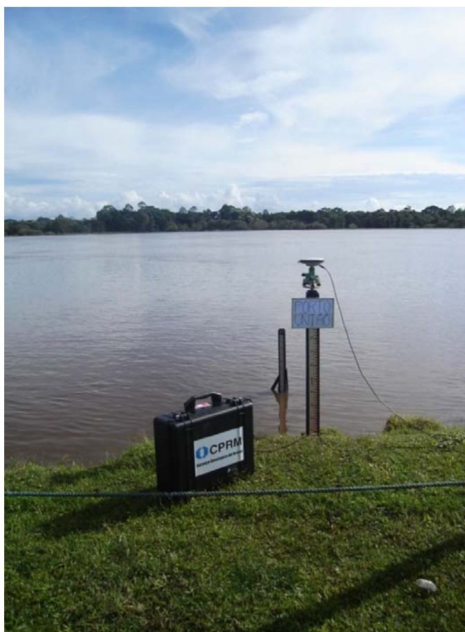
Figura 6.6- Ocupação de um lance de régua por receptor GPS para nivelamento da estação fluviométrica de Porto União.
