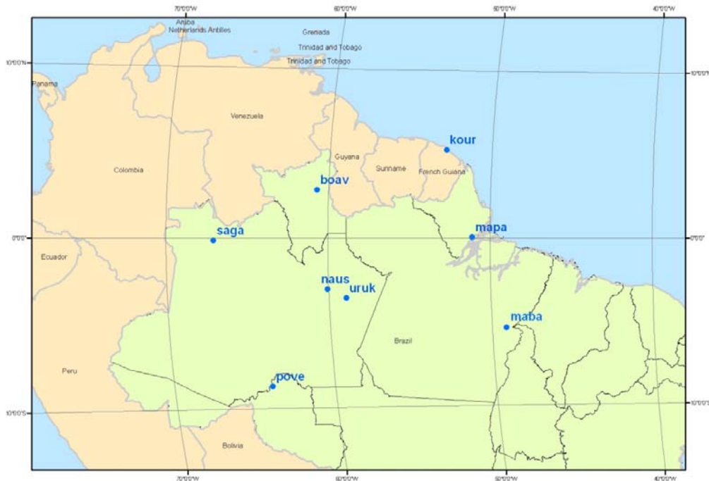
Figura 5.4- Rede local a ajustar com 6 estações da RBMC, 1 estação IGS na Guiana Francesa e 1 estação permanente instalada pela CPRM e o IRD.
