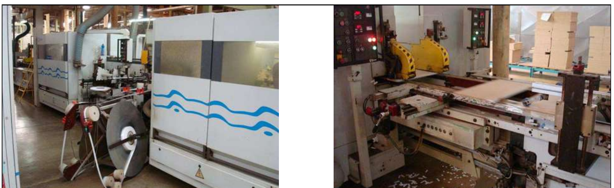
Ilustr. 60 - Coladeiras de borda e alimentador com destopador automático. Santos Andirá Ind.Móveis Ltda., PR. Maio/2008. Fotos do autor.
