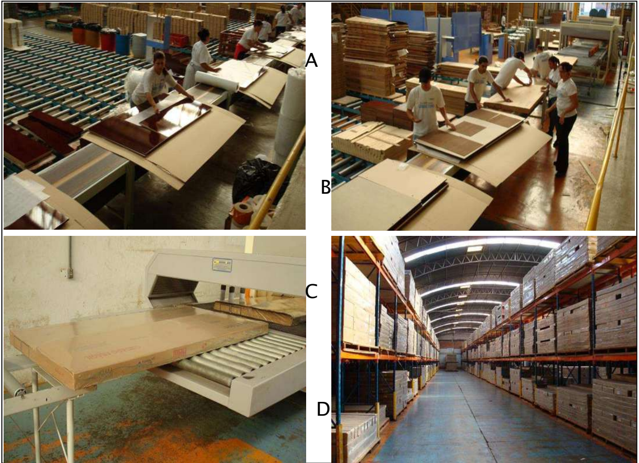
Ilustr. 78 – Ilustração da sequencia de montagem de uma embalagem de móvel.
