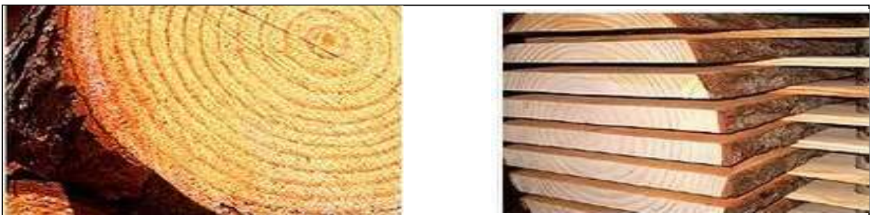
Ilustr. 02 - Desdobro de uma tora de madeira em pranchas
