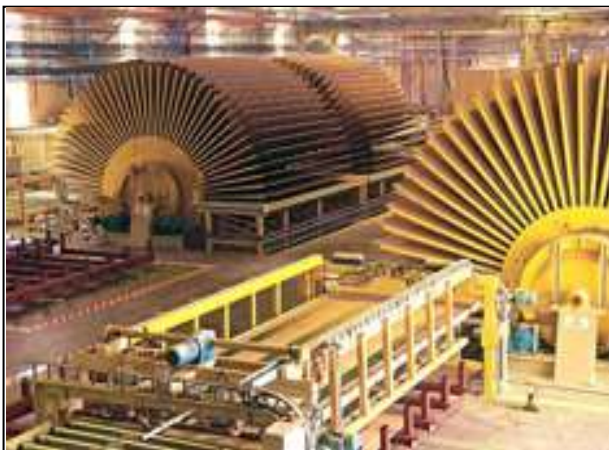
Ilustr. 18 – Processo de fabricação do Aglomerado : climatizadores
