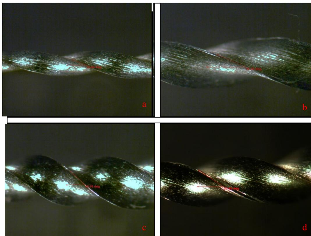
**Fig. 7** Ângulo da última hélice dos instrumentos de conicidade; a) 4 mm/mm, b) 6 mm/mm, c) 8 mm/mm e d) 10mm/mm.
