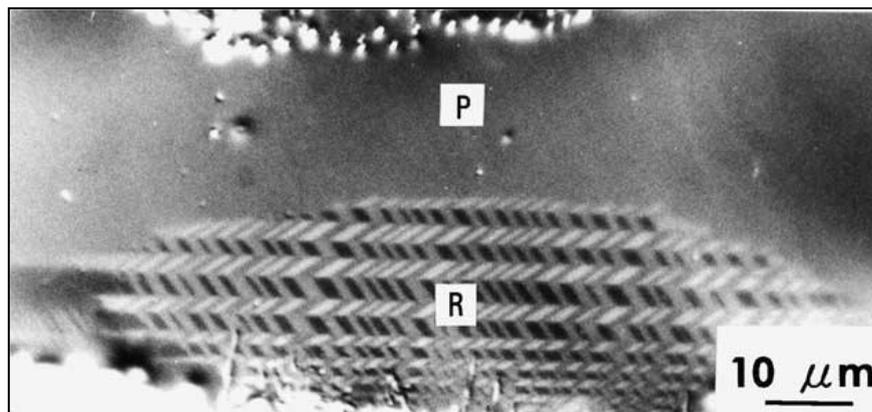
**Fig. 1** Imagem publicada por Otsuka & Ren (2005). Microscopia óptica observação da transformação B2–R para a liga Ti50.3Ni48.2Fe1.5 . Morfologia típica da fase R é notada. P: fase parente. R: Fase-R [Fukuda et al.(1992) reproduzido com permissão do instituto japonês de metais].
