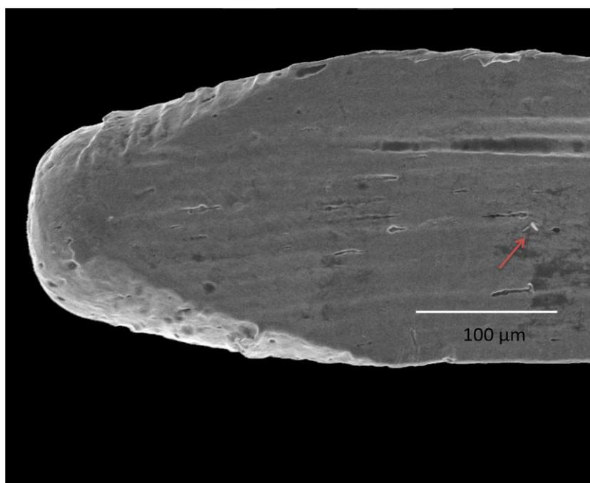
**Fig. 13** Ponta do instrumento de conicidade 0,04 mm/mm com aumento de 300x. Seta indicando acabamento ruim do instrumento com presença de farpas.
