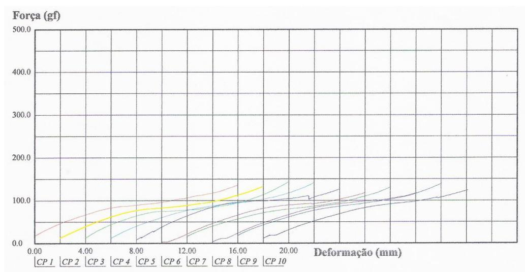
**Fig. 15** Gráfico tensão deformação das limas TF<sup>®</sup> de conicidade 0,04 mm/mm.
