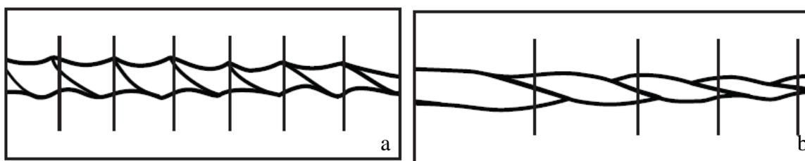
**Fig. 18** Passo da hélice constante (a) e variável (b). TF<sup>®</sup> Technical Bulletin 2008.
