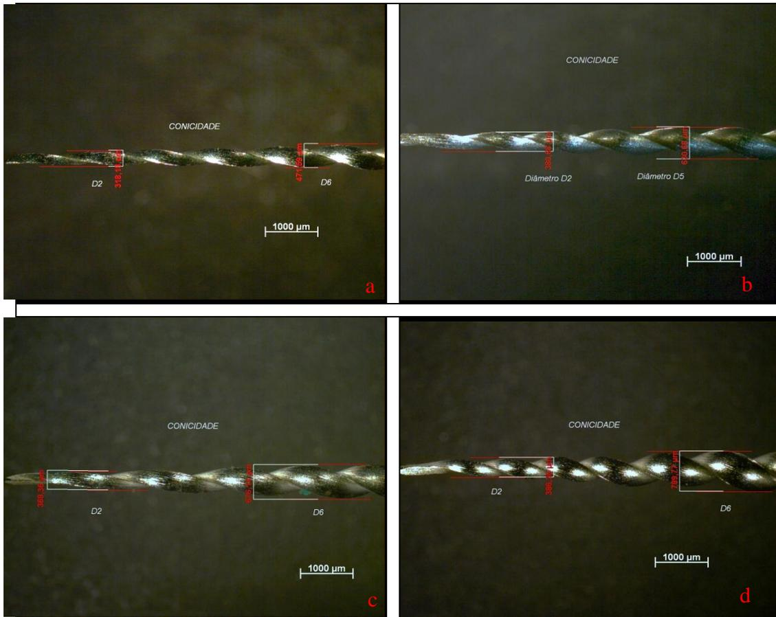
**Fig. 8** Imagens para o cálculo da conicidade dos instrumentos TF<sup>®</sup> de (a) 0,04mm/mm, (b) 0,06 mm/mm, (c) 0,08 mm/mm e (d) 1,0 mm/mm.
