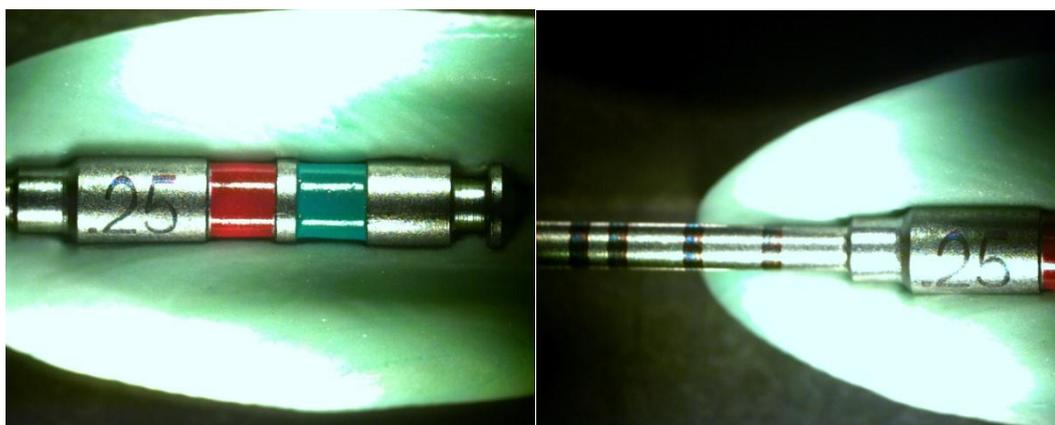
**Fig. 19** Fixação do intermediário através de uma base de silicone pesado. Aumento de 1,6x com objetiva de 1,0x. O instrumento fica preso em uma posição fixa padrão mesmo depois da troca.
