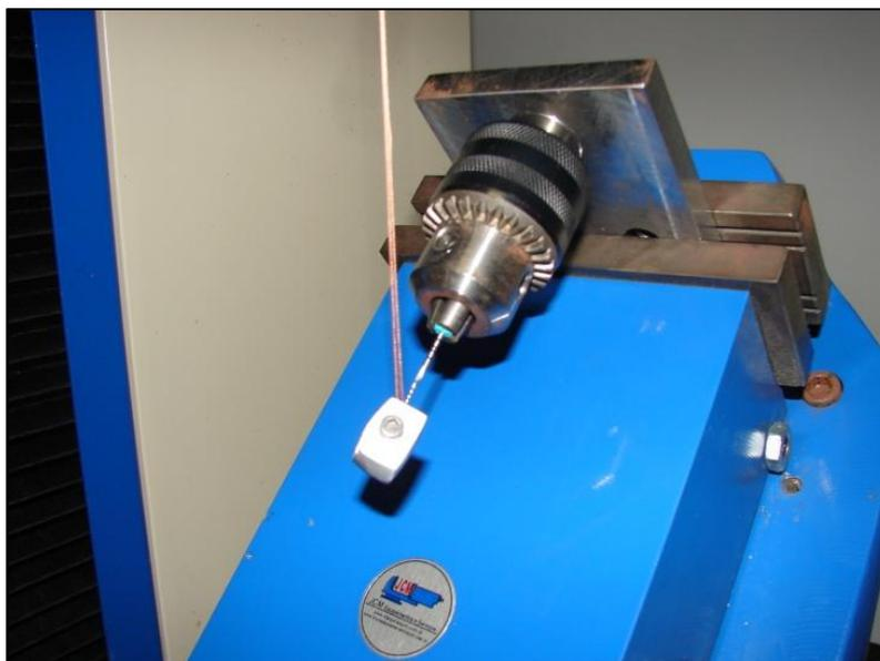
**Fig. 4** Lima TF<sup>®</sup> inserida na morsa e presa por um mandril de Jacob. O instrumento fica em uma angulação de 45° e é tracionado por um ponto fixo à 3mm da ponta onde está fixada uma morsa desenvolvida propriamente para o ensaio.
