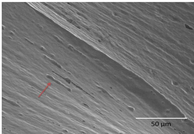
**Fig. 12** Imagem do mesmo instrumento com aumento de 500x. Seta indicando defeito na aresta. Notam-se também crateras no acabamento do material.
