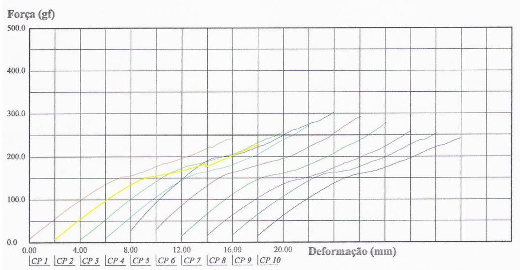
**Fig. 16** Gráfico tensão deformação dos instrumentos TF<sup>®</sup> conicidade 0,06 mm/mm
