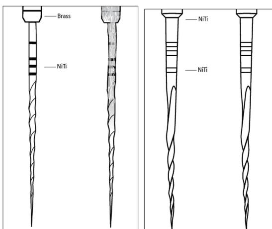
**Fig. 21** Corrosão galvânica causada por outro metal na haste de fixação (a). Ausência da corrosão devido a presença da haste de NiTi. TF<sup>®</sup> Technical Buletin 2008.
