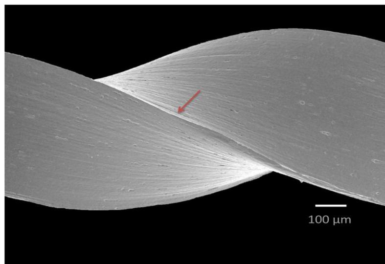
**Fig. 11** Depressão presente na hélice de um instrumento TF<sup>®</sup> conicidade 0,08mm/mm aumento de 100x. Além disto, pode-se observar a disposição das marcas de usinagem ao longo eixo do instrumento.
