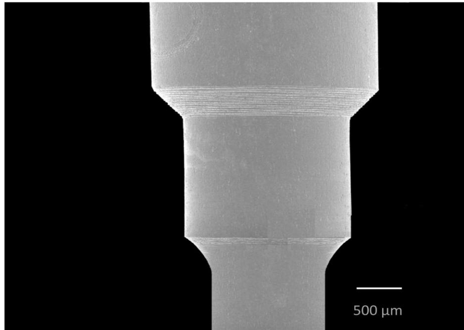
**Fig. 14** Junção entre o intermediário e a haste de fixação. Aumento de 27x.
