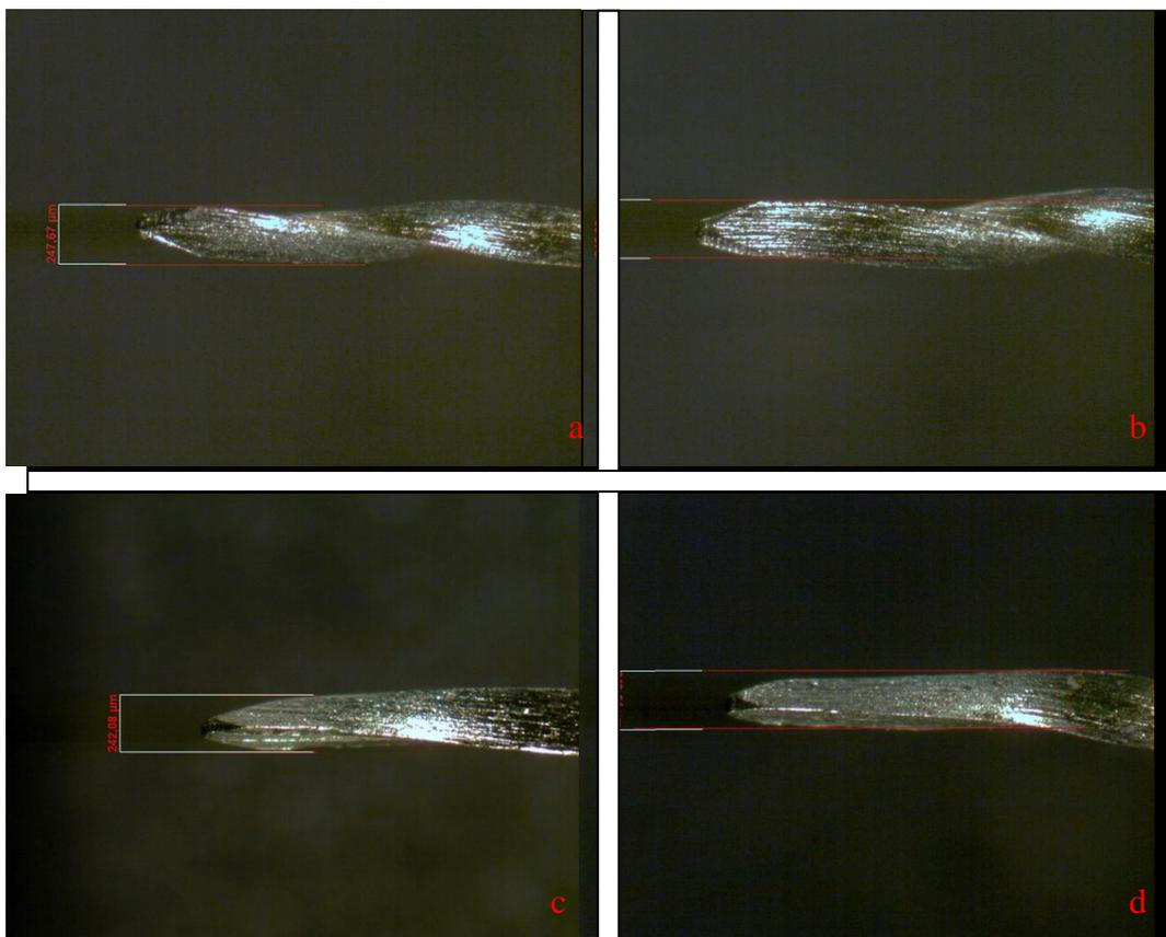
**Fig. 9** Medidas da base da ponta dos instrumentos TF<sup>®</sup> de conicidade (a) 0,04; (b) 0,06; (c) 0,08 e (d) 0,1 mm/mm.
