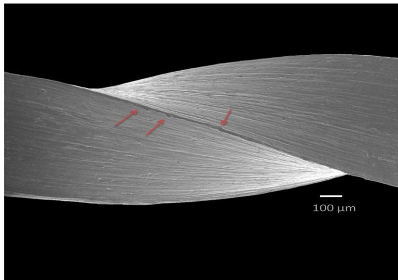
**Fig. 10** Imagem da lima TF<sup>®</sup> de conicidade 0,04mm/mm em um aumento de 60x. Setas indicando rebarbas remanescentes devido ao acabamento inadequado do instrumento. Podem-se observar marcas de usinagem ao longo eixo do instrumento.
