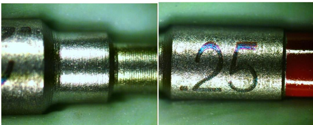
**Fig. 20** a) O intermediário é usinado a partir da haste de fixação aumento de 1,6x objetiva 1,0x . b) As marcações do instrumento são feitas a laser.
