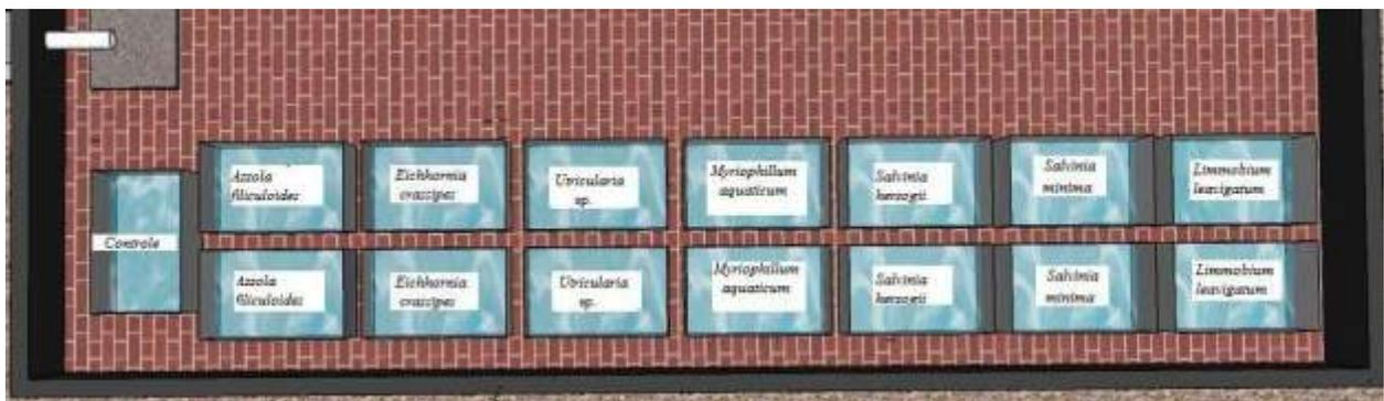
Figura 7 - Vista superior do sistema por batelada com os detalhes da distribuição das macrófitas em cada reservatório
