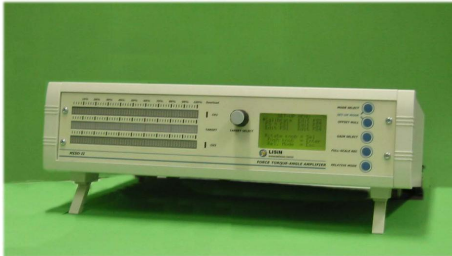
Figura 3.2: Aparelho Amplificador de dois canais biomecânicos MISO II. Fonte: Manual do equipamento.
