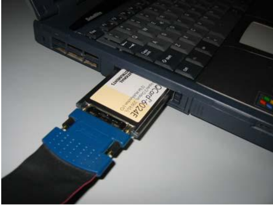
Figura 3.4: Placa conversora analógico-digital de aquisição de dados PCMCIA. Fonte: Manual do equipamento.
