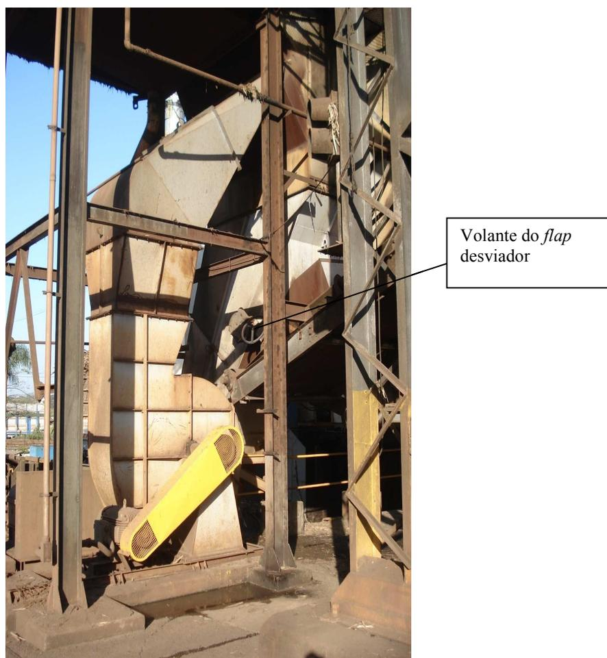
Figura 29 – Conjunto ventilador e bico soprador.
