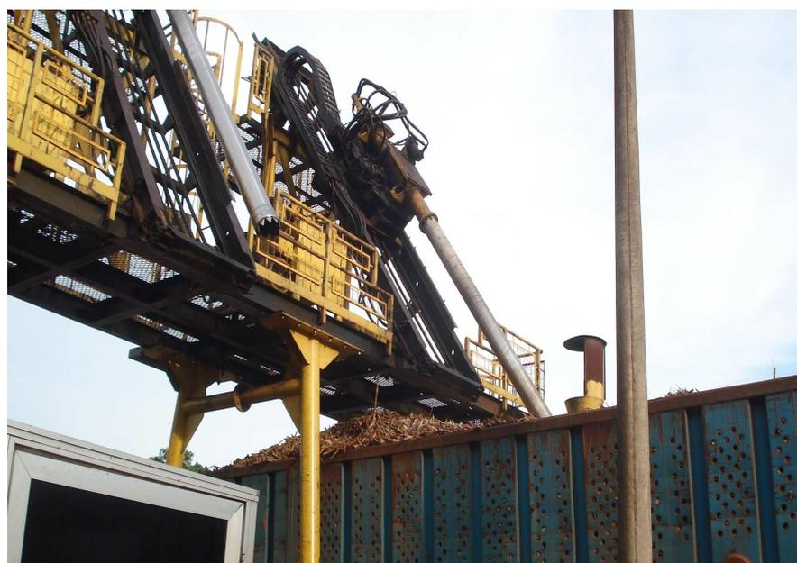
Figura 31 – Sonda oblíqua de amostragem de cana-de-açúcar em operação.
