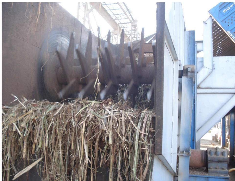
Figura 28 – Nivelador instalado na esteira de cana-de-açúcar.
