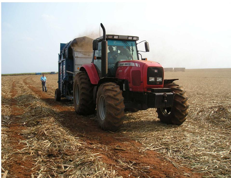
Figura 20 - Colhedora *Twyster Press 5000* em operação recolhendo palhço sem enleiramento.
