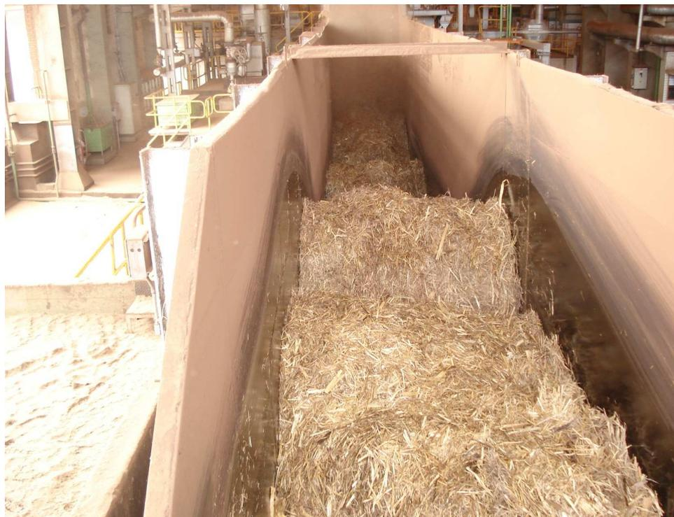
Figura 26 – Palhiço sendo conduzido à moenda pelas esteiras transportadoras.
