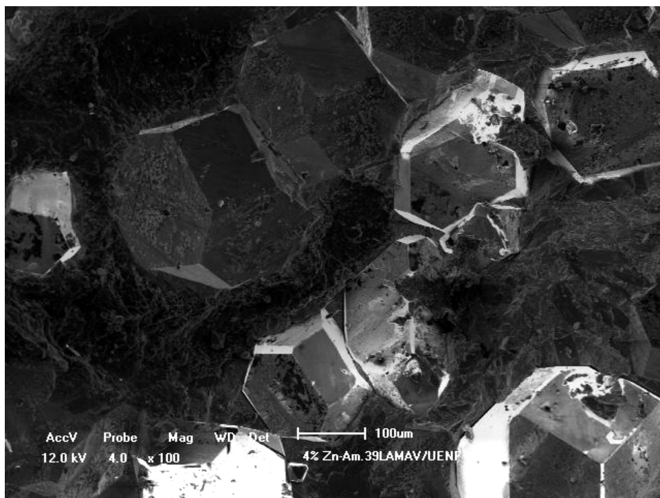
Figura 27 – Região de fratura; detalhe da morfologia dos cristais, 4%Zn.
