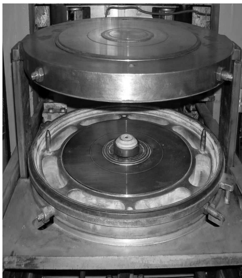
Figura 12 – Dispositivo de alta pressão (DAP) do tipo bigorna com concavidade central. DAP com a cápsula montada e instalada.
