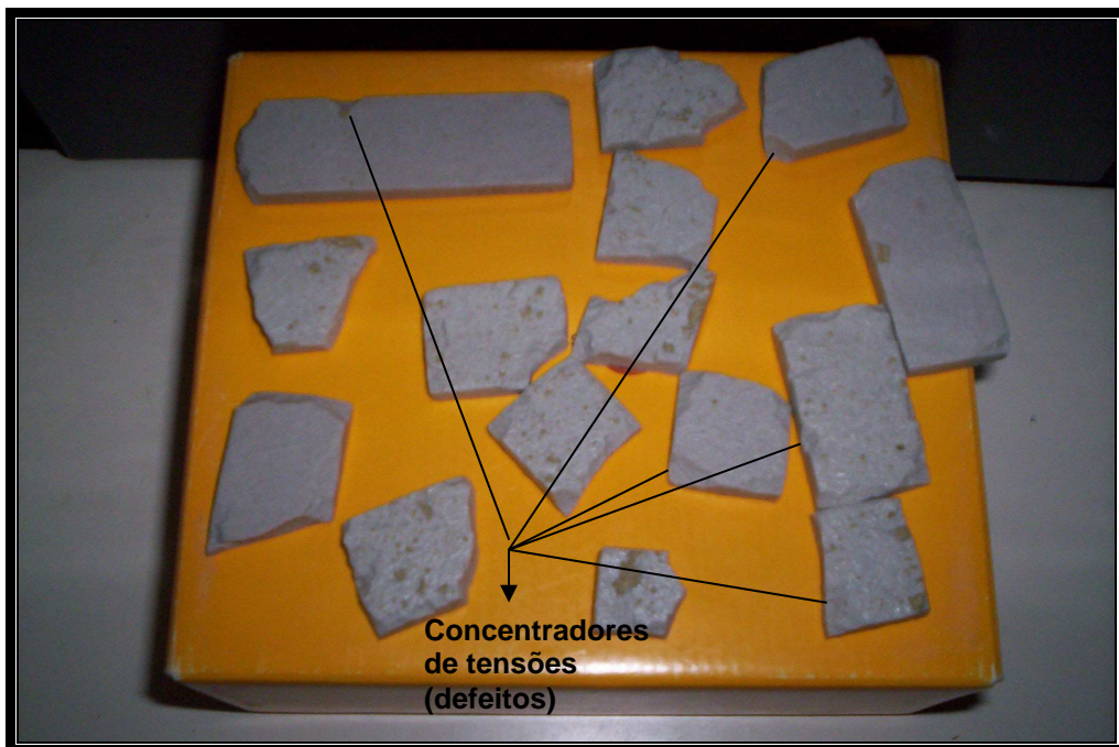
Figura 4.54 – Pontos concentradores de tensões (massa cerâmica MBIV).
