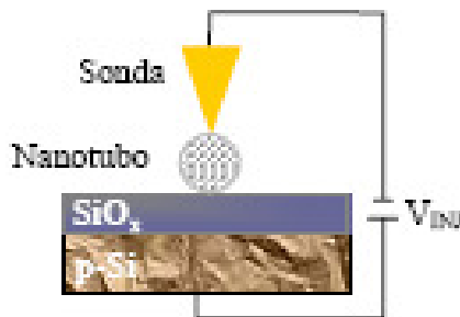
Figura 2.4. Detalhe do dispositivo de aplicação de carga em um NTC (BARBOZA, 2008).
