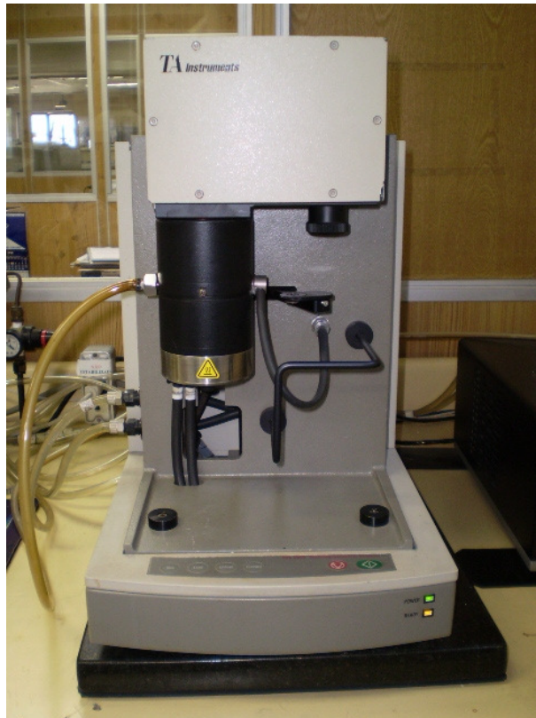
Figura 3.8: Ilustração do equipamento de análise termogravimétrica – TA Instruments - Modelo 2050.
