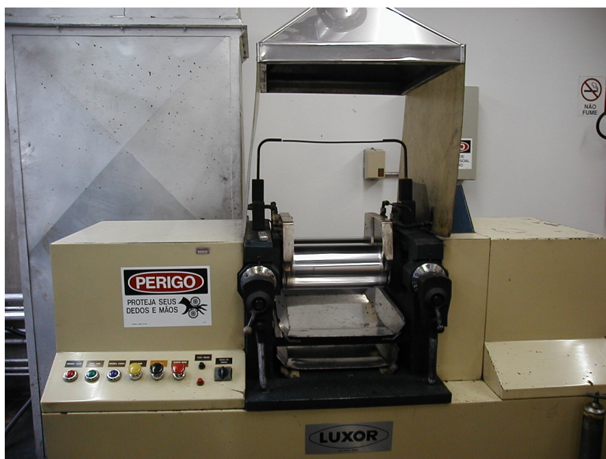
Figura 3.1: Ilustração da misturador Luxor, MBL 150 utilizado na preparação das formulações.
