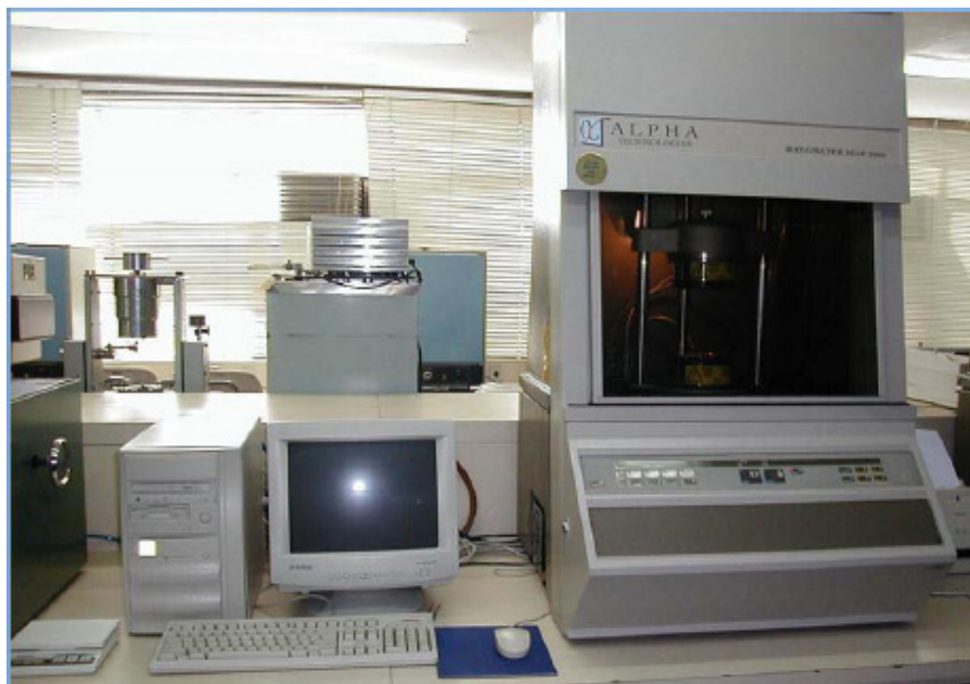
Figura 3.3: Ilustração do Reômetro MDR 2000 – Alpha Technologies utilizado na determinação das propriedades reológicas.
