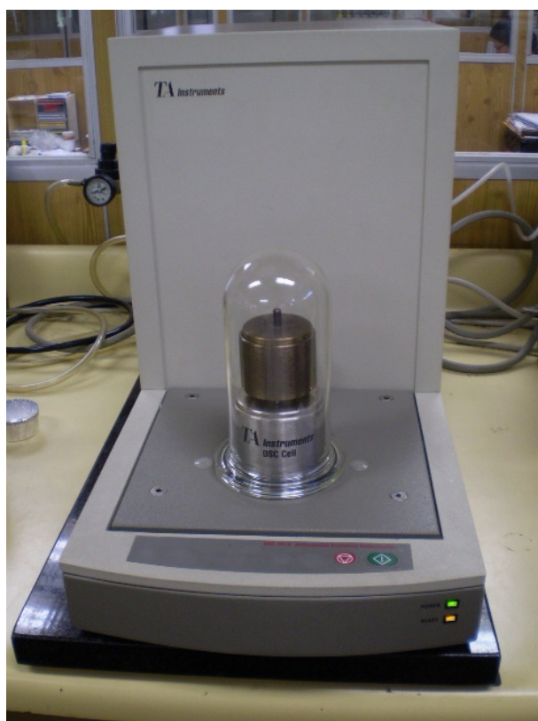
Figura 3.9: Ilustração do equipamento de calorimetria exploratória diferencial (DSC) – TA Instruments - Modelo 2010.
