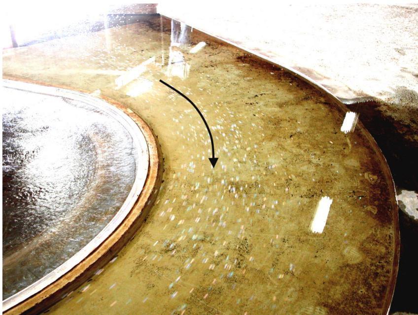
FIGURA 41 – VERTEDOIRO LIVRE – TRECHO CURVO – VAZÃO DE 720 m<sup>3</sup>/s
