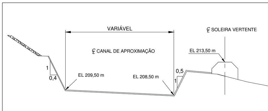
FIGURA 22 – SEÇÃO DO CANAL DE APROXIMAÇÃO
