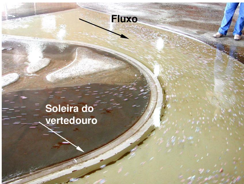
FIGURA 25 – CONDIÇÃO INICIAL – VAZÃO DE 720 m<sup>3</sup>/s – FLUXO NO TRECHO CURVILÍNEO DO CANAL
