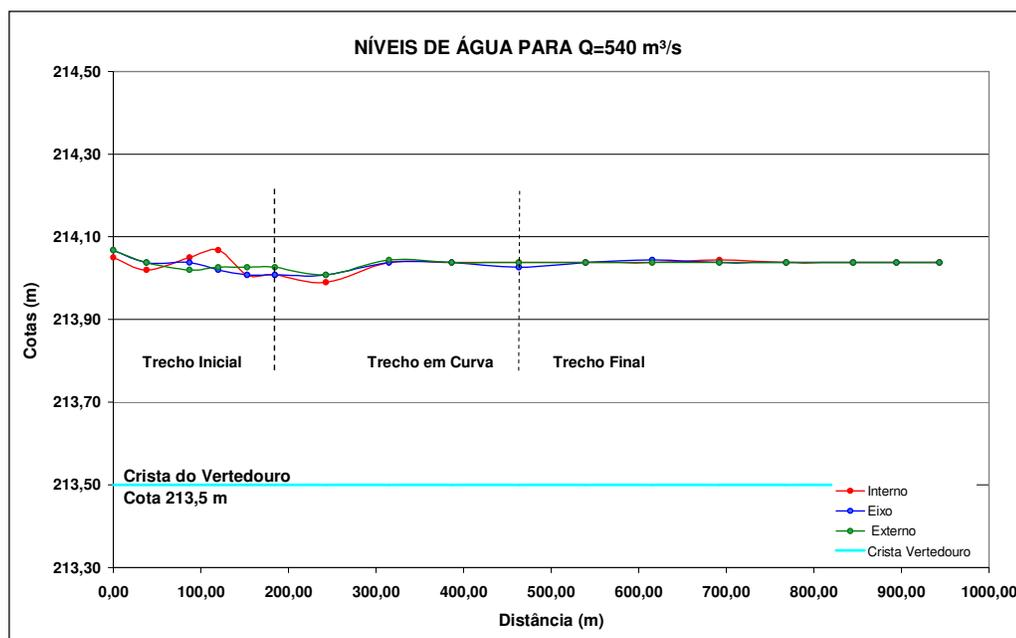
FIGURA 28 – CONDIÇÃO INICIAL – VAZÃO DE 540 m<sup>3</sup>/s – NÍVEIS DE ÁGUA MEDIDOS AO LONGO DO CANAL DE ADUÇÃO
