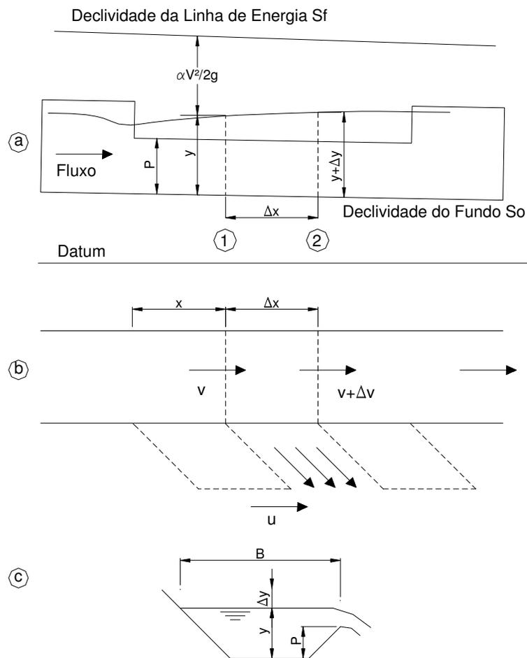
FIGURA 9 – ESQUEMA DE UM CANAL COM DESCARGA NO VERTEDOIRO LATERAL – A) ELEVAÇÃO – B) PLANTA – C) SEÇÃO
