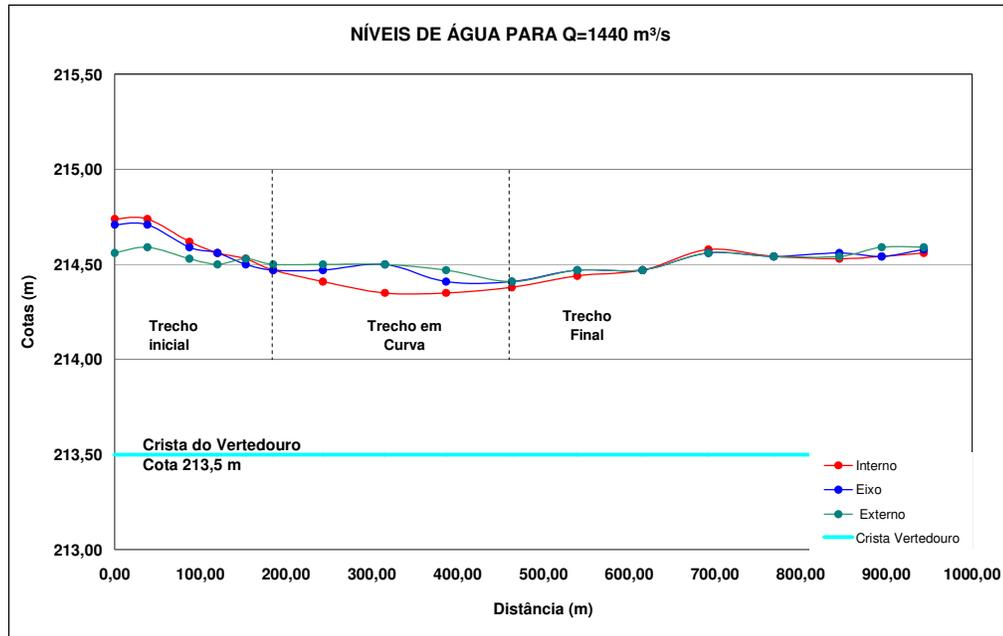
FIGURA 50 – VERTEDOURO LIVRE – VAZÃO DE 1440 m<sup>3</sup>/s – NÍVEIS DE ÁGUA MEDIDOS AO LONGO DO CANAL DE APROXIMAÇÃO
