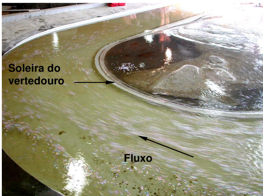
FIGURA 26 – CONDIÇÃO INICIAL – VAZÃO DE 1440 m<sup>3</sup>/s – FLUXO NO TRECHO CURVILÍNEO DO CANAL
