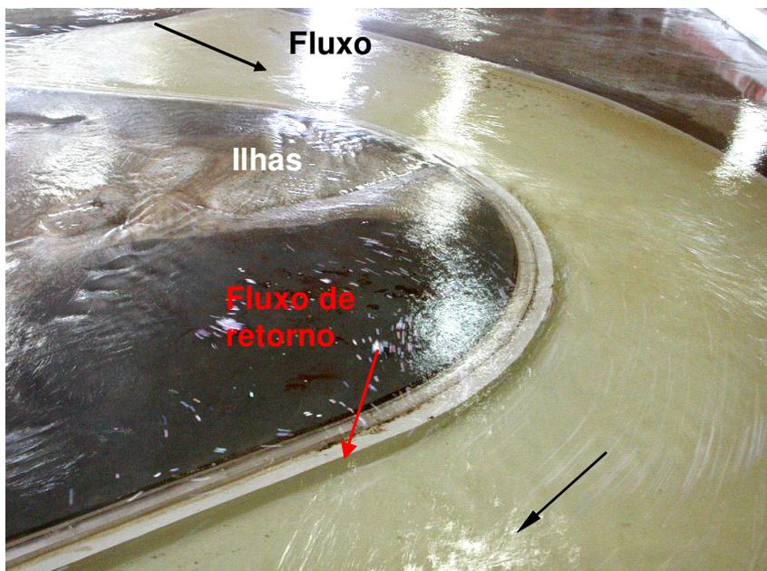
FIGURA 27 – CONDIÇÃO INICIAL – VAZÃO DE 2880 m<sup>3</sup>/s – FLUXO NO TRECHO CURVILÍNEO DO CANAL
