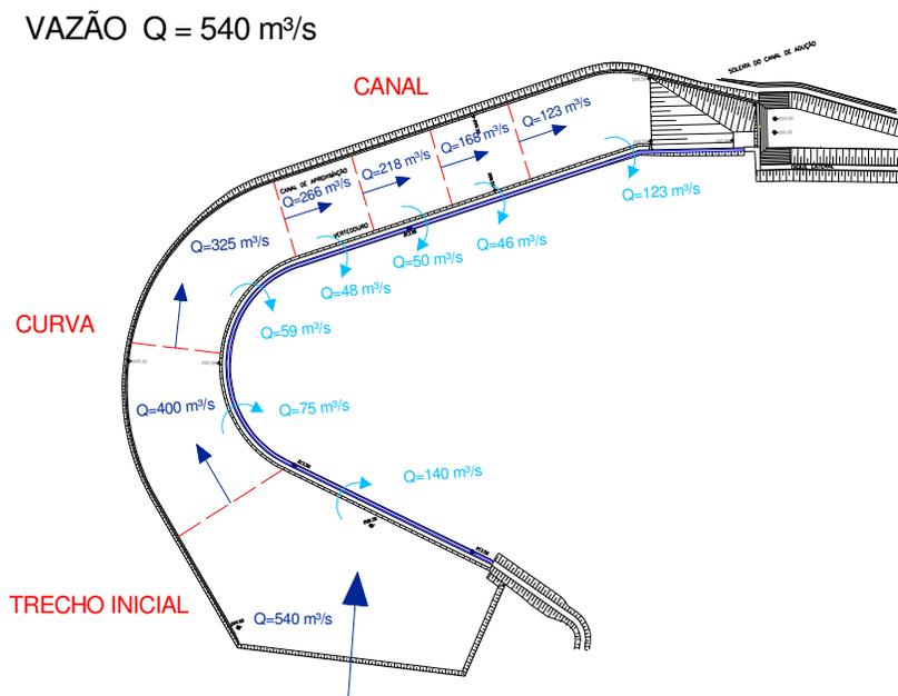
FIGURA 56 – VAZÕES MEDIDAS POR TRECHO DO VERTEDOURO – VAZÃO DE ALIMENTAÇÃO  $540 \text{ m}^3/\text{s}$
