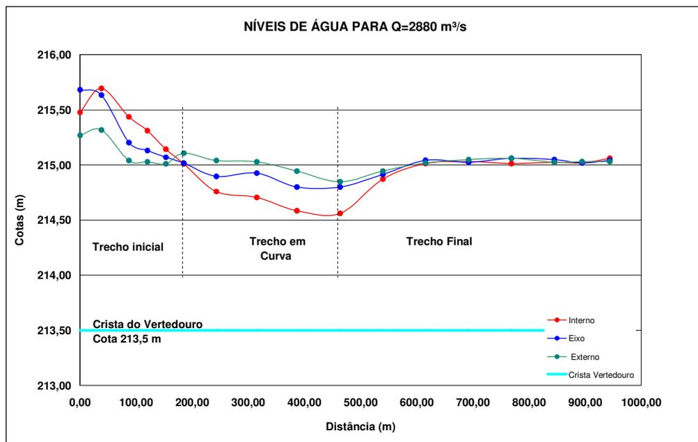
FIGURA 51 – VERTEDOURO LIVRE – VAZÃO DE 2880 m<sup>3</sup>/s – NÍVEIS DE ÁGUA MEDIDOS AO LONGO DO CANAL DE APROXIMAÇÃO
