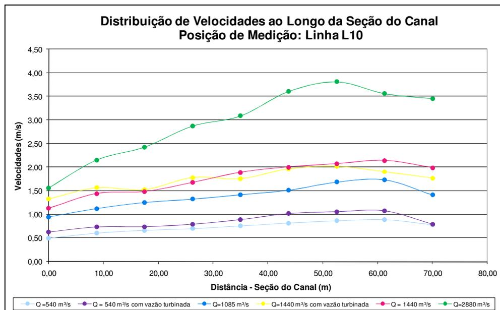
FIGURA 62 – VARIAÇÃO DE VELOCIDADE AO LONGO DA SEÇÃO DO CANAL NA POSIÇÃO L10
