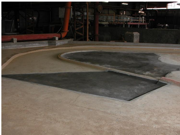
FIGURA 37 – VERTEDOIRO LIVRE – ALTERAÇÕES EXECUTADAS NO TRECHO INICIAL DO CANAL
