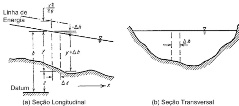
FIGURA 8 – DESENHO ESQUEMÁTICO PARA DEFINIÇÃO DA EQUAÇÃO DA RESISTÊNCIA
