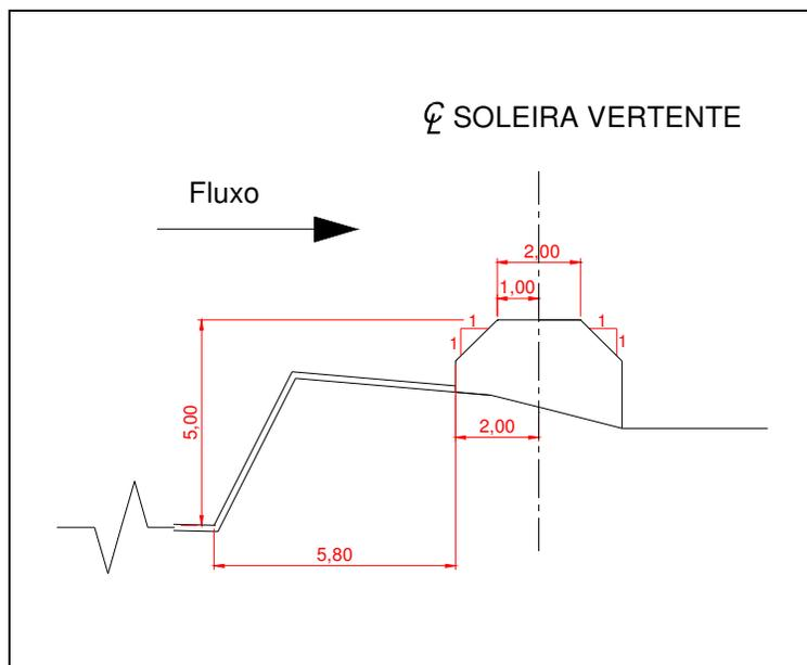
FIGURA 23 – SEÇÃO DA SOLEIRA DO VERTEDOURO
