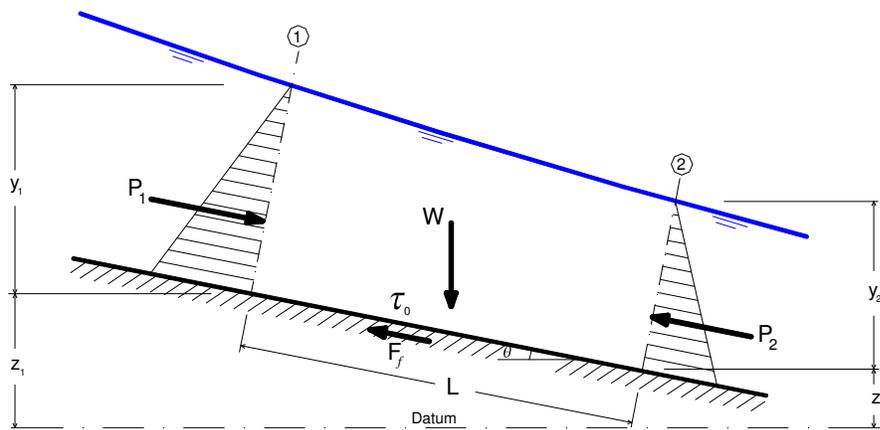
FIGURA 4 – APLICAÇÃO DA QUANTIDADE DE MOVIMENTO EM CANAIS
