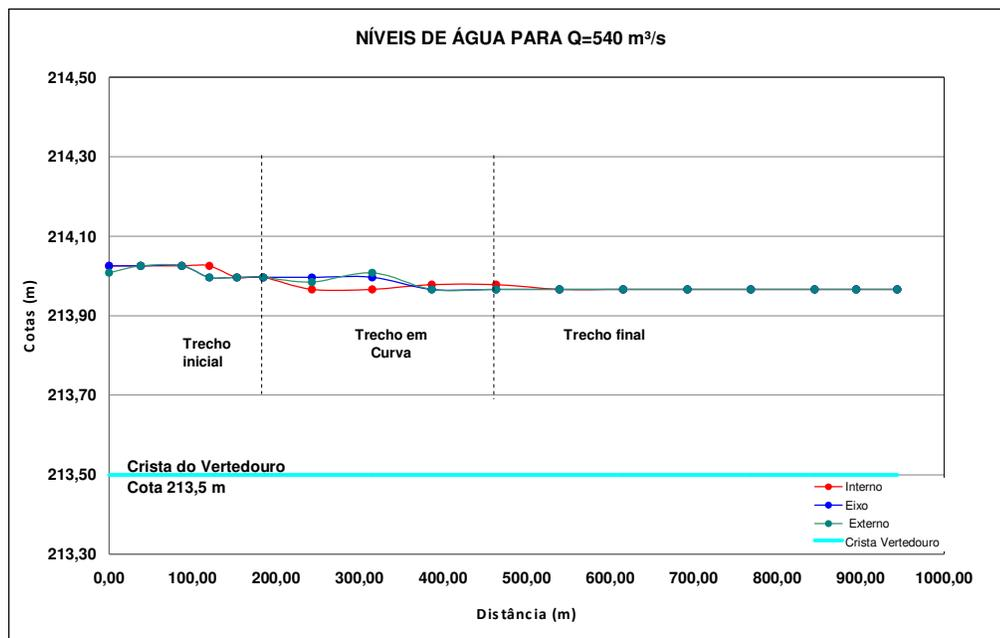
FIGURA 49 – VERTEDOURO LIVRE – VAZÃO DE 540 m<sup>3</sup>/s – NÍVEIS DE ÁGUA MEDIDOS AO LONGO DO CANAL DE APROXIMAÇÃO
