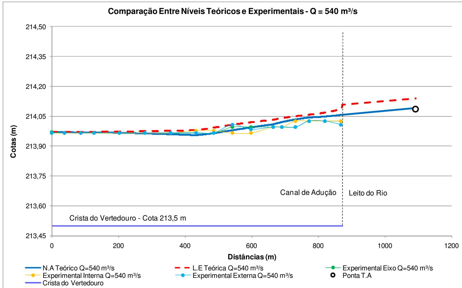
FIGURA 68 – COMPARAÇÃO ENTRE NÍVEIS TEÓRICOS E EXPERIMENTAIS – CÁLCULO SEQÜENCIAL – VAZÃO Q=540 m<sup>3</sup>/s
