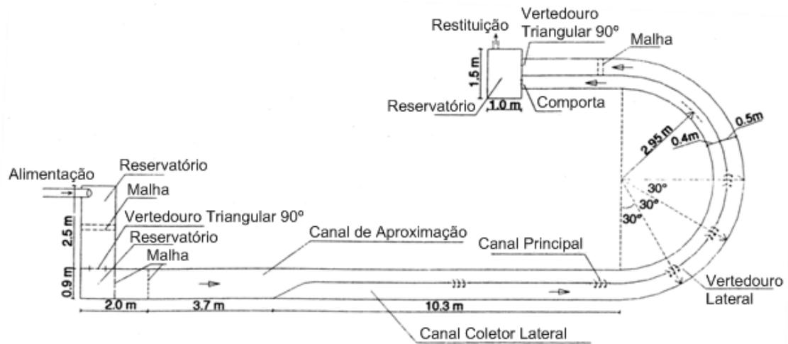
FIGURA 13 – VERTEDOURO LATERAL TRIANGULAR LOCADO NO LADO EXTERNO DE UMA CURVA
