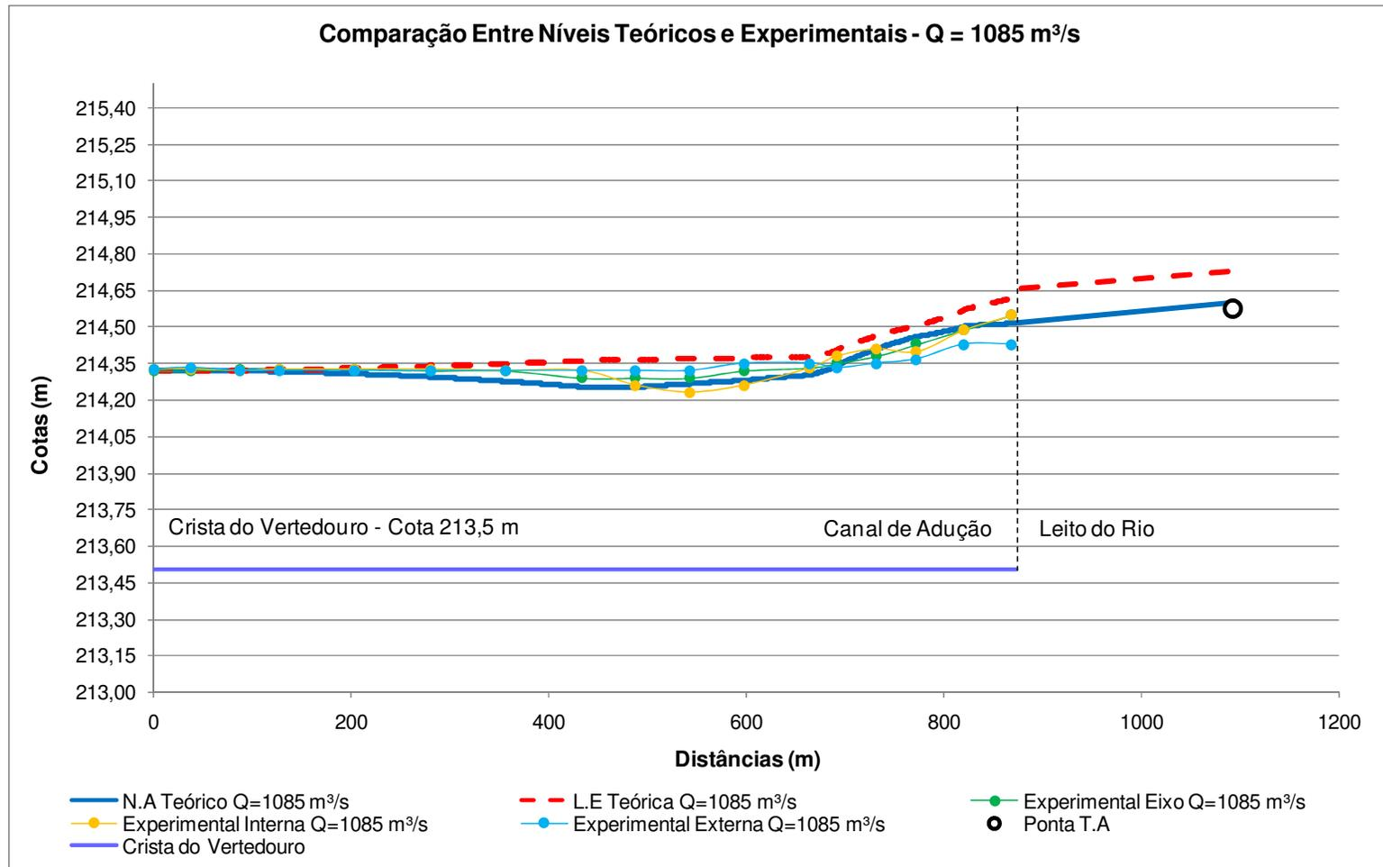
FIGURA 69 – COMPARAÇÃO ENTRE NÍVEIS TEÓRICOS E EXPERIMENTAIS – CÁLCULO SEQÜENCIAL – VAZÃO Q=1085 m<sup>3</sup>/s
