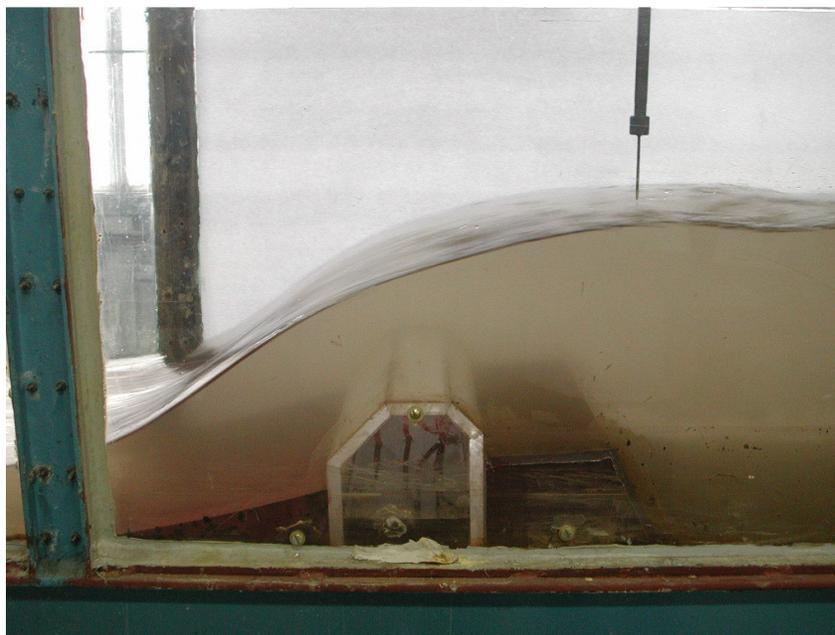
FIGURA 33 – MODELO SECCIONAL – PERFIL DO ESCOAMENTO
