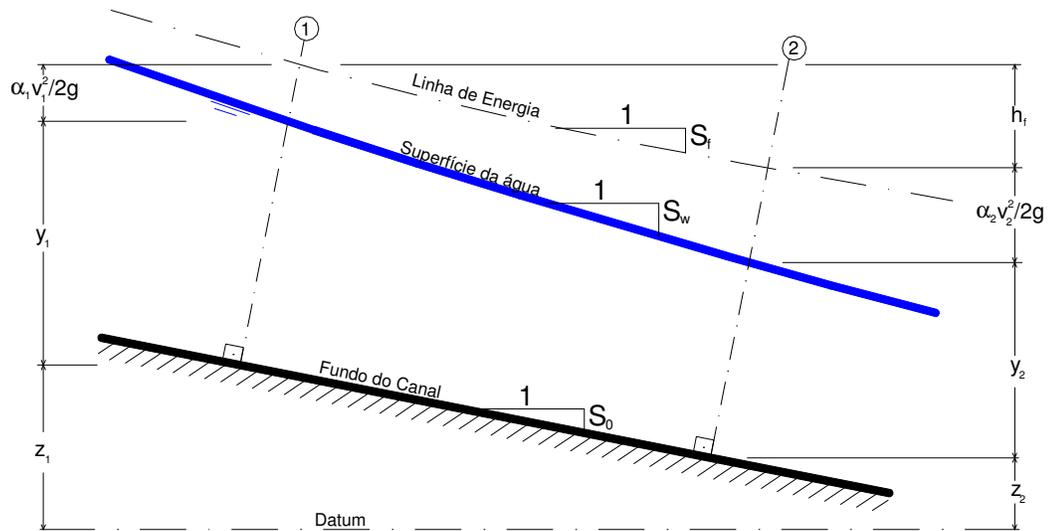
FIGURA 1 – APLICAÇÃO DO PRINCÍPIO DA ENERGIA EM CANAIS
