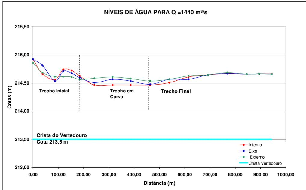
FIGURA 29 – CONDIÇÃO INICIAL – VAZÃO DE 1440 m<sup>3</sup>/s – NÍVEIS DE ÁGUA MEDIDOS AO LONGO DO CANAL DE ADUÇÃO
