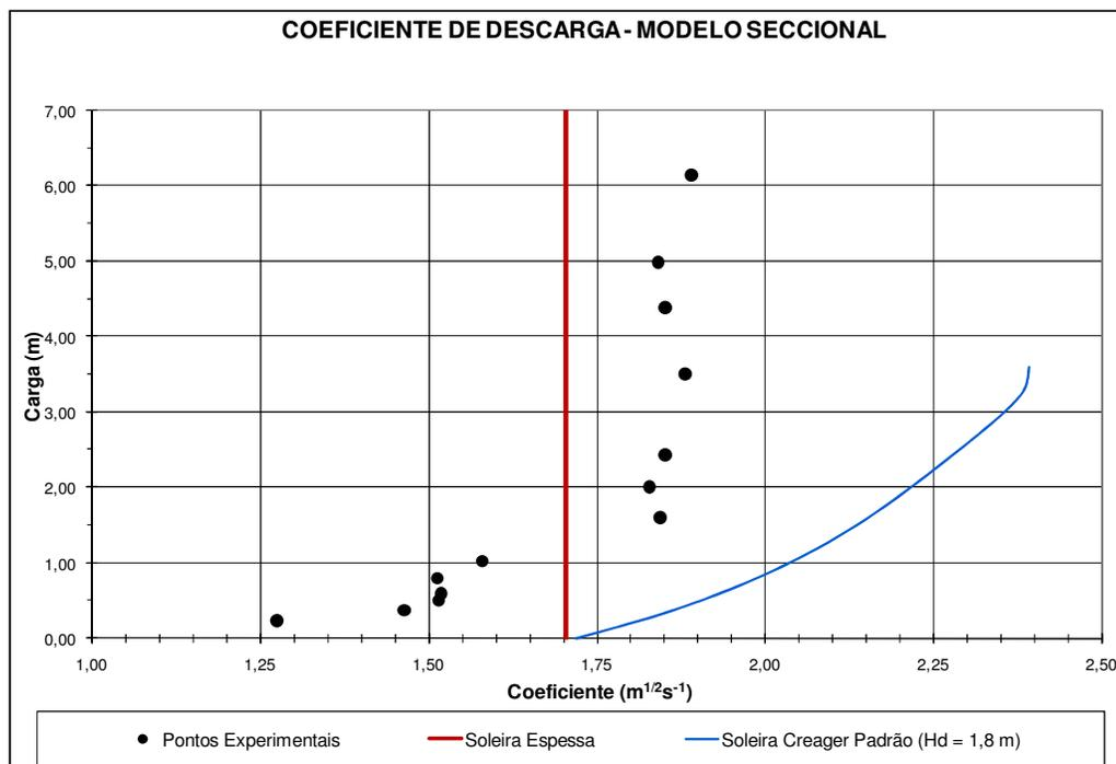
FIGURA 34 – COEFICIENTES DE DESCARGA PARA MODELO SECCIONAL
