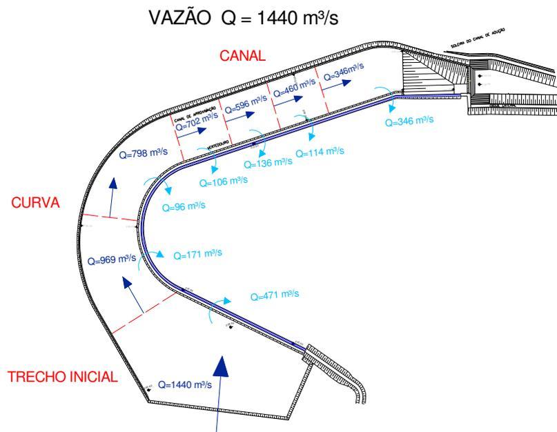
FIGURA 57 – VAZÕES MEDIDAS POR TRECHO DO VERTEDOURO – VAZÃO DE ALIMENTAÇÃO  $1440 \text{ m}^3/\text{s}$
