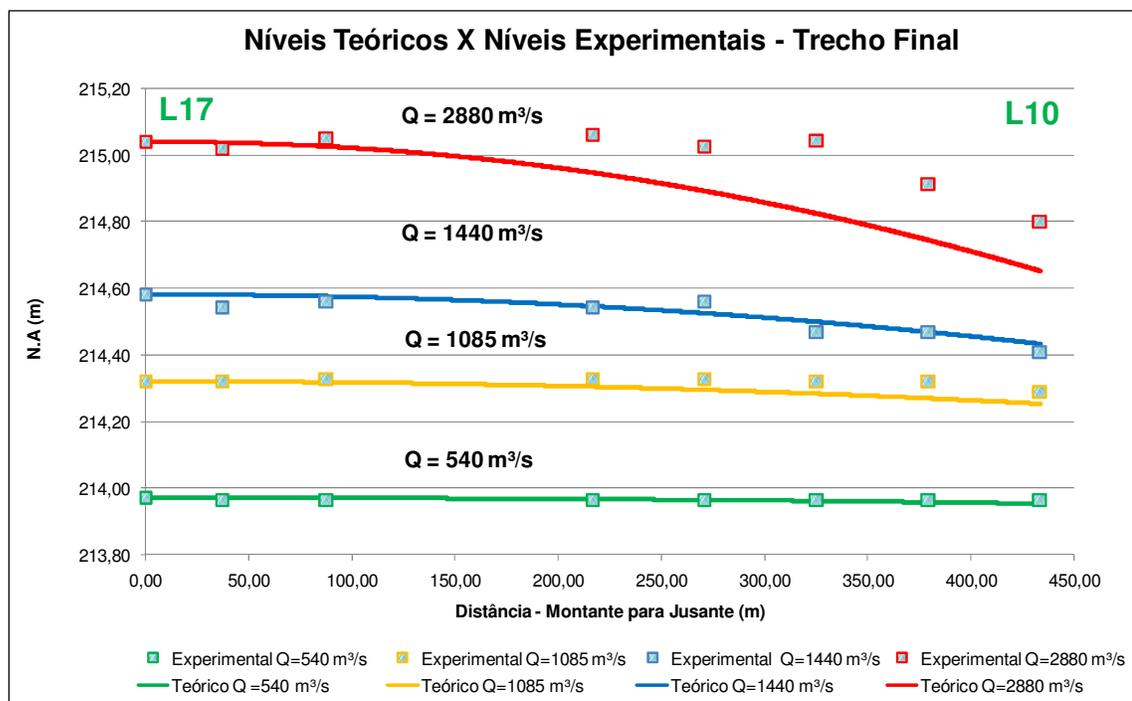
FIGURA 59 – TRECHO FINAL DO VERTEDOURO – NÍVEIS EXPERIMENTAIS X NÍVEIS TEÓRICOS – EFEV DERIVADA DO PRINCÍPIO DA QUANTIDADE DE MOVIMENTO – COEFICIENTE DE MAY PARA SOLEIRA TRAPEZOIDAL
