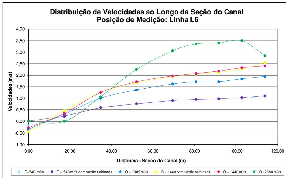
FIGURA 60 – VARIAÇÃO DE VELOCIDADE AO LONGO DA SEÇÃO DO CANAL NA POSIÇÃO L6
