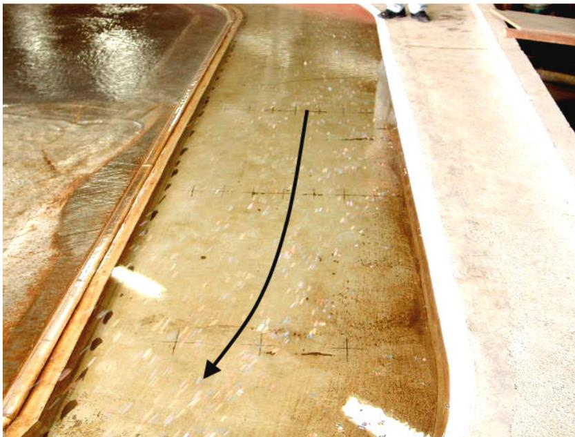
FIGURA 45 – VERTEDOIRO LIVRE – TRECHO FINAL – VAZÃO DE 1440 m<sup>3</sup>/s – COM VAZÃO TURBINADA
