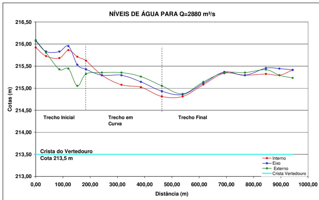
FIGURA 30 – CONDIÇÃO INICIAL – VAZÃO DE 2880 m<sup>3</sup>/s – NÍVEIS DE ÁGUA MEDIDOS AO LONGO DO CANAL DE ADUÇÃO
