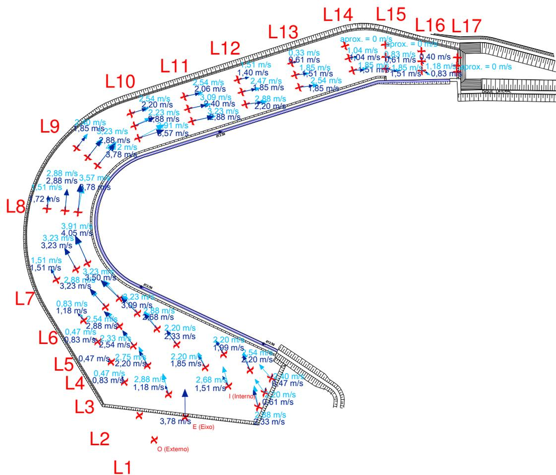
FIGURA 55 – VERTEDOIRO LIVRE –  $Q = 2880 \text{ m}^3/\text{s}$  – VARIAÇÃO DE VELOCIDADES AO LONGO DO CANAL
