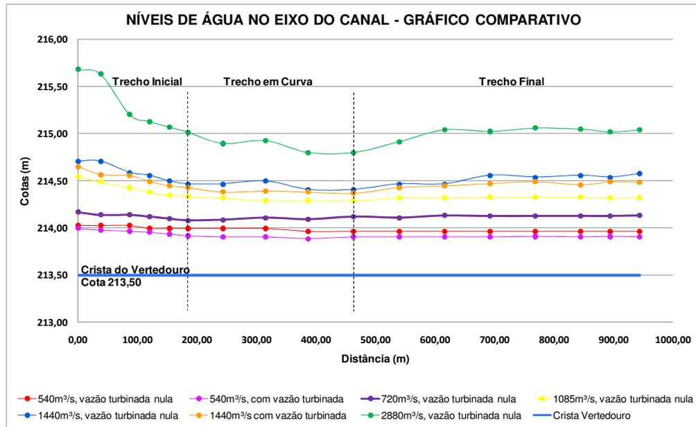
FIGURA 52 – VERTEDOURO LIVRE – COMPARATIVO ENTRE NÍVEIS DE ÁGUA MEDIDOS AO LONGO DO CANAL DE APROXIMAÇÃO
