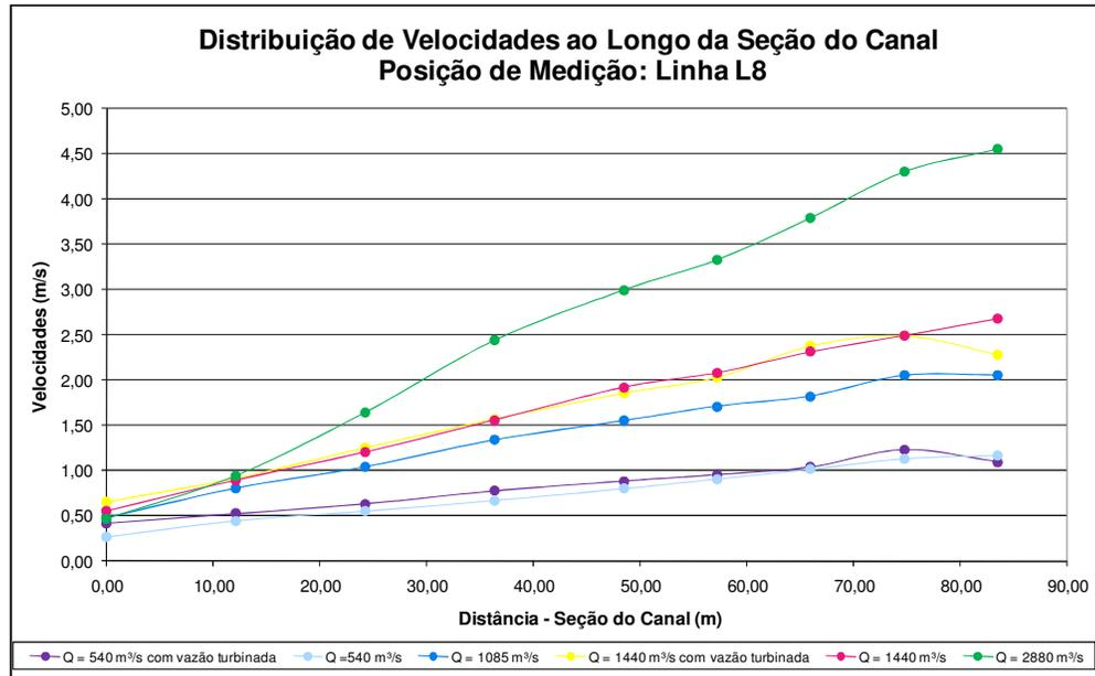
FIGURA 61 – VARIAÇÃO DE VELOCIDADE AO LONGO DA SEÇÃO DO CANAL NA POSIÇÃO L8
