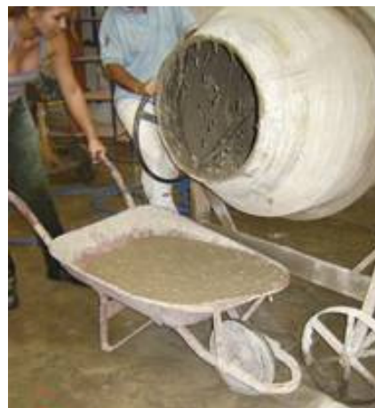
(d) Transporte do CAA para concretagem
