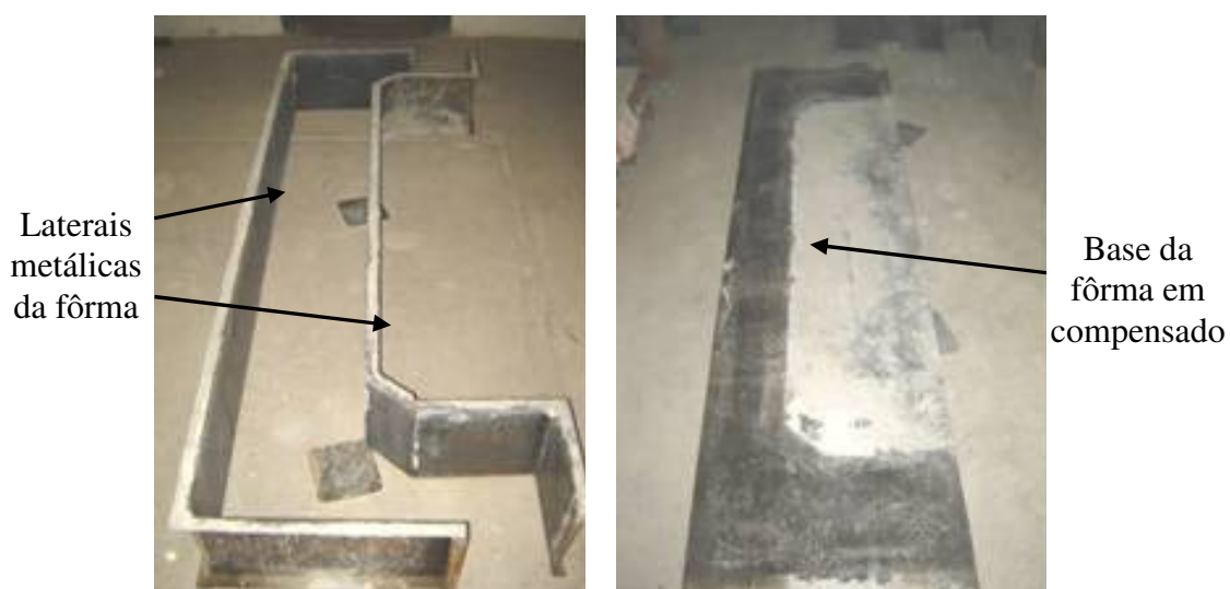
Figura 3.7 – Fôrma utilizada para moldagem dos pilares
