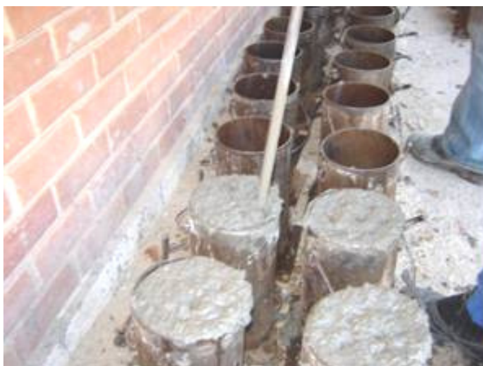
Figura 3.11 – Moldagem dos corpos de prova
