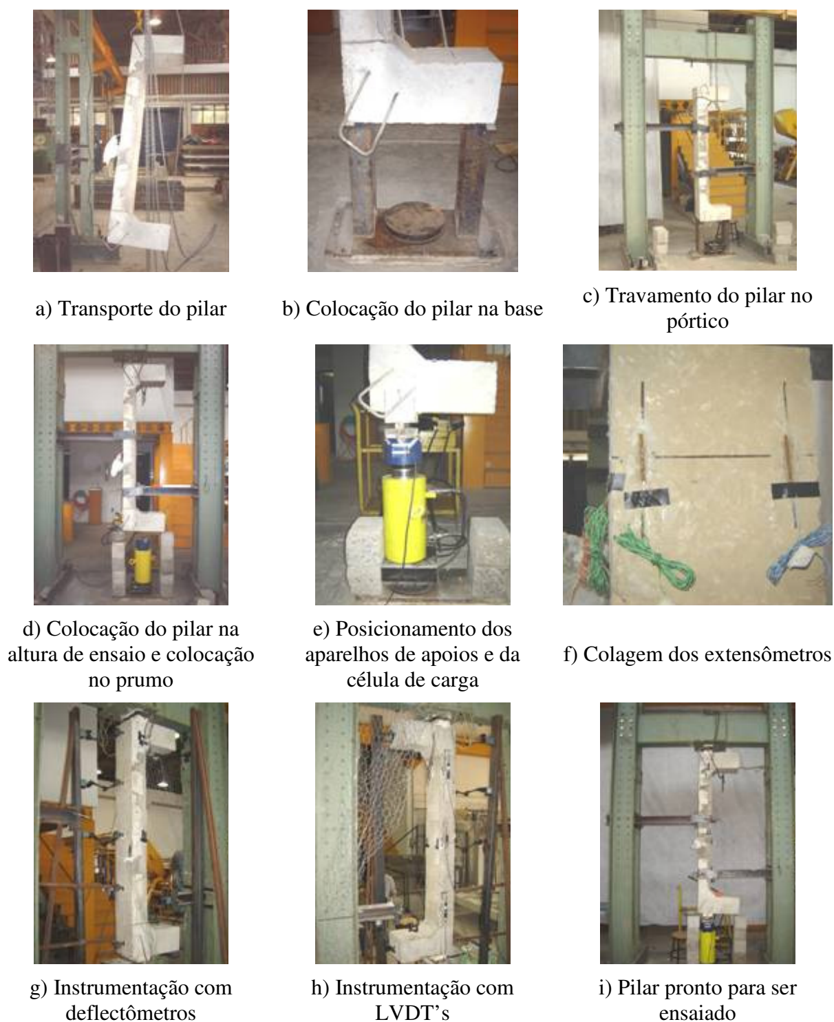
Figura 3.27 – Esquema de montagem do ensaio de pilar
