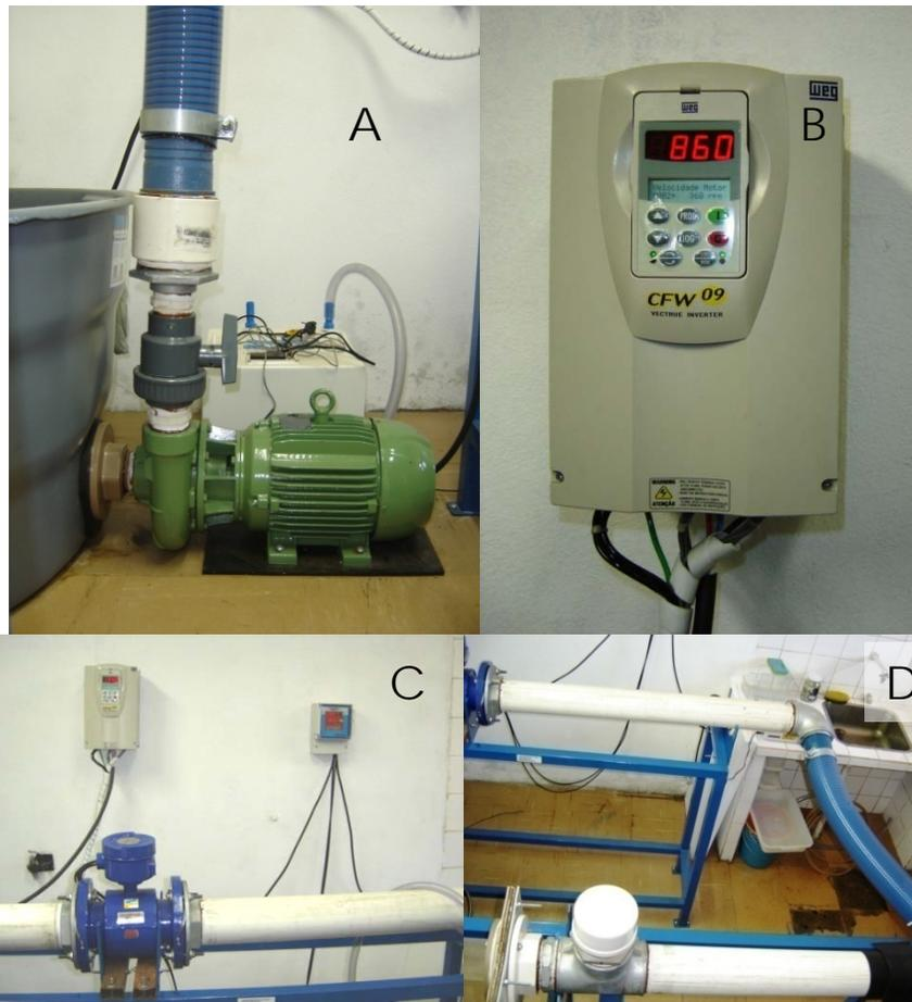
FIGURA 2. Detalhes dos equipamentos utilizados no aparato hidráulico. Bomba centrífuga e registro de entrada (A); inversor de frequência (B); medidor de vazão (em azul) com leitor acoplado (C) e seção em curva feita por joelhos e tubo flexível (D).
