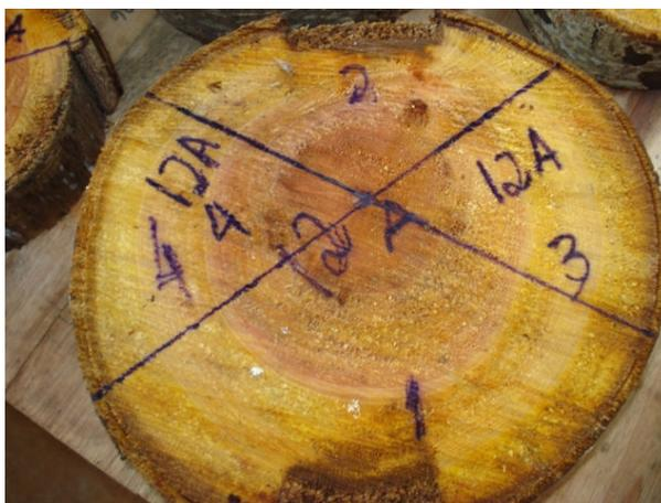
FIGURA 8 Disco retirado a 1.30m do solo para avaliação da densidade básica
