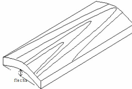
FIGURA 13 Esquema de medição do encaçamento das tábuas.
