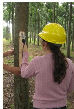
FIGURA 2 e 3 Stress waver timer utilizado para a obtenção da velocidade de propagação das ondas de tensão
