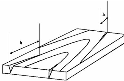
FIGURA 9 Método de medição das rachaduras de topo nas peças.
