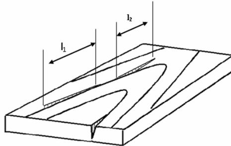
FIGURA 10 Esquema da medição da rachadura de superfície.
