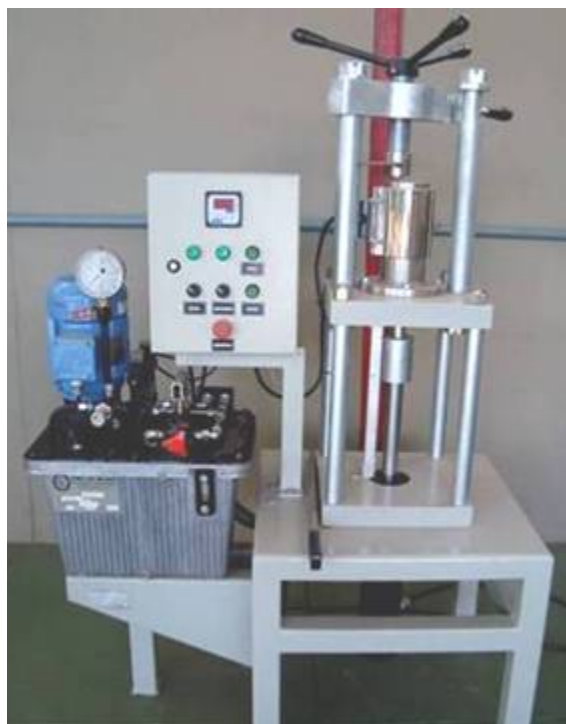
FIGURA 2 Briquetadeira hidráulica para laboratório.
