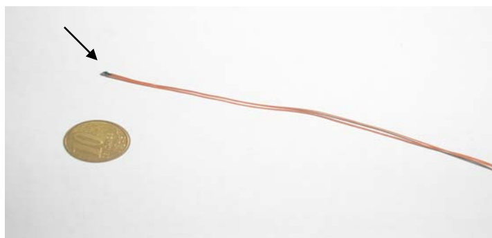
FIGURA 12 – COMPARAÇÃO DA DIMENSÃO DO SENSOR NTC A UMA MOEDA.
