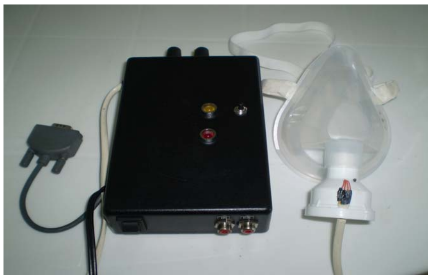
FIGURA 18 – SISTEMA DE SINCRONISMO Á PARTIR DA DETECÇÃO DO SINAL RESPIRATÓRIO QUE É CAPTADO PELOS SENSORES NTC POSICIONADOS NA MÁSCARA RESPIRATÓRIA.
