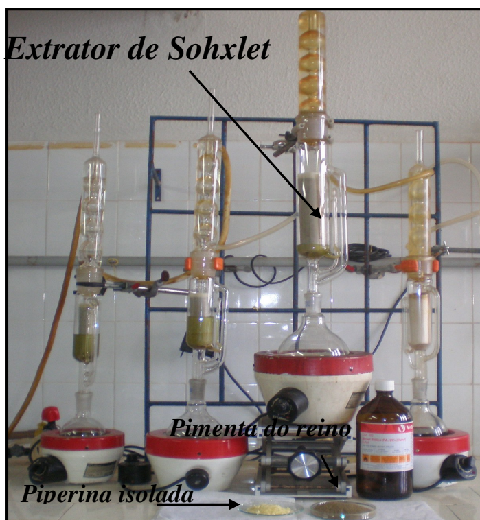
Figura 29. Extrator de Soxhlet acoplado à manta de aquecimento e condensador.
