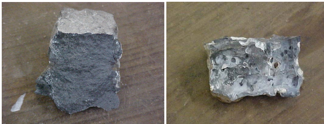
Figura 4.10 – Amostras rígida e porosa de um mesmo lote de escória.
