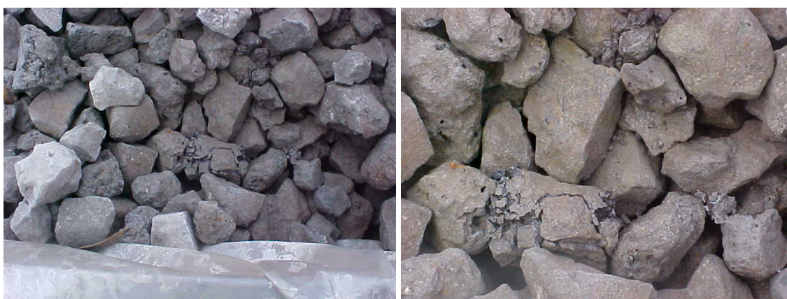
Figura 4.25 – Fotos (após 70 dias) da escória ME1 após o processo de cura nos tanques, indicando os efeitos da expansão e fragmentação dos materiais.
