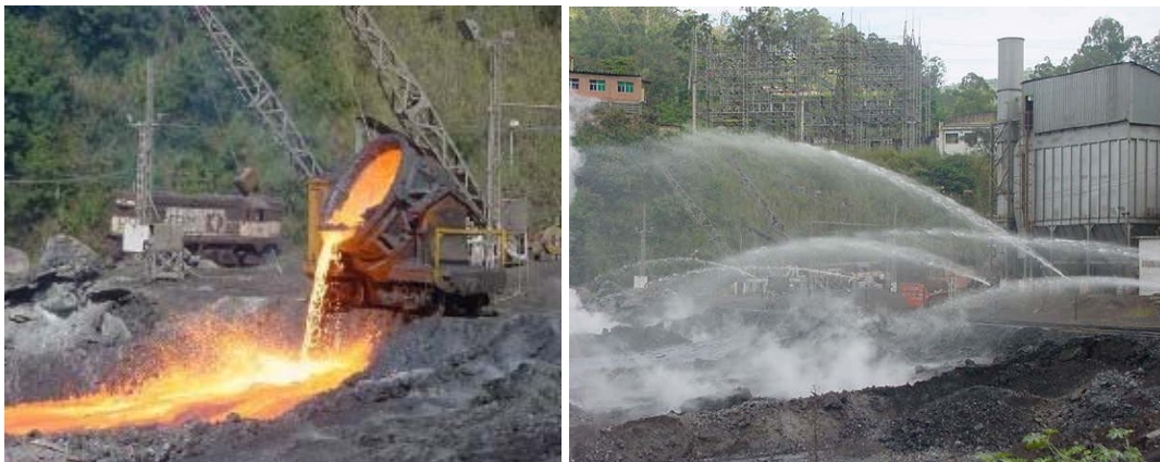
Figura 2.15 – (a) Basculamento e (b) Resfriamento da escória.
