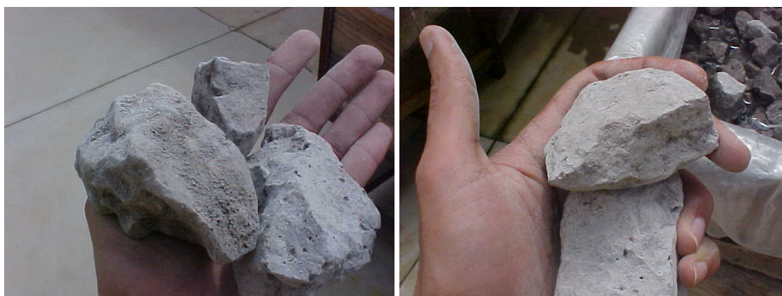
Figura 4.26 – Fragmentos da escória ME2 completamente impregnados por uma película de \text{CaCO}_3 precipitado (o material não possuía este aspecto no início do processo de cura).
