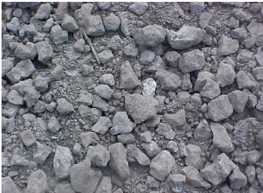
Figura 5.1 – Excesso de finos em lote de escória para utilização na EFVM.
