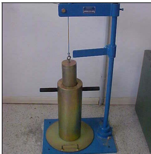
Figura 3.9 – Aparelho ‘Treton’ para medidas de resistência ao impacto.
