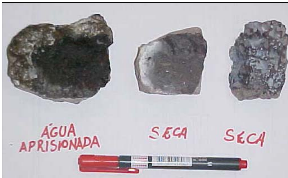
Figura 5.6 – Presença de água no interior de um corpo-de-prova guardado à sombra por 60 dias (presença da umidade indicada pela coloração escura da amostra à esquerda).
