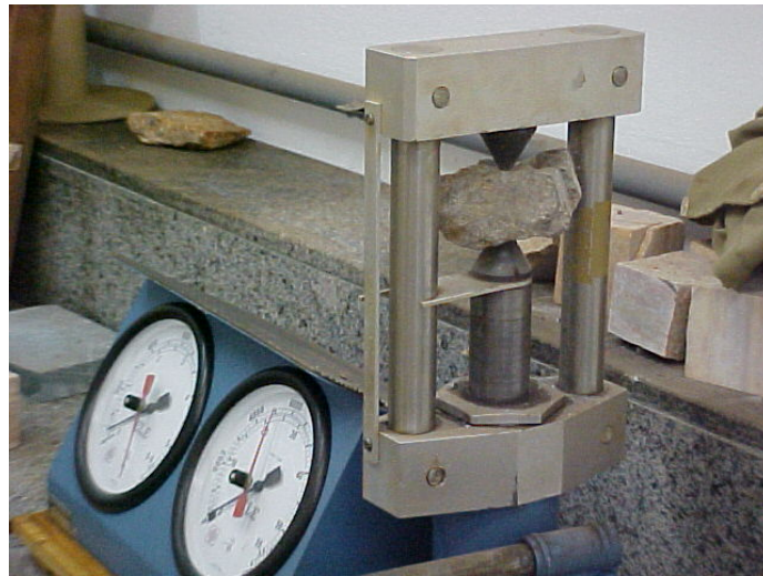
Figura 3.13 – Sistema de aplicação e execução de ensaio de carga pontual.
