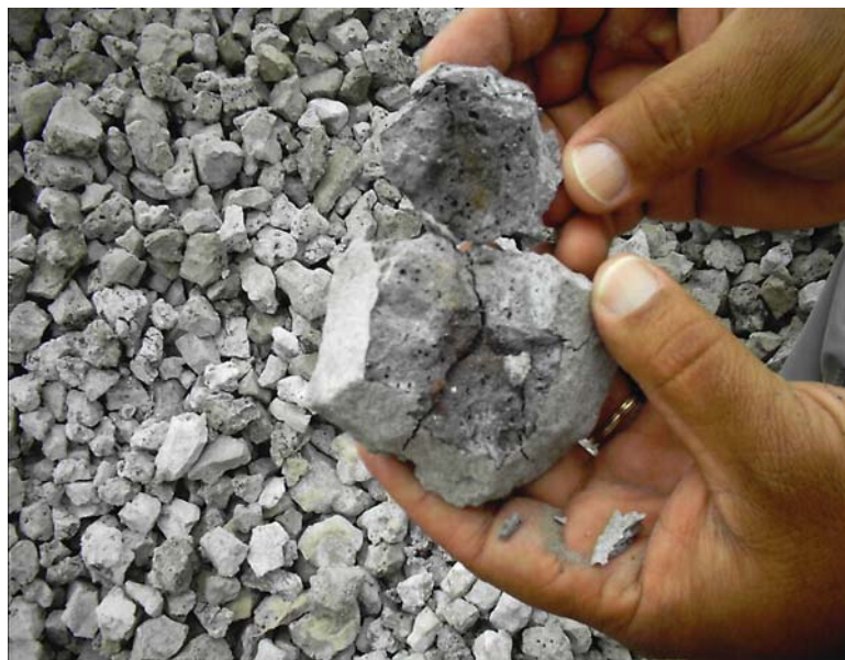
Figura 5.4 – Fragmento de escória fracionado por efeitos de expansão.
