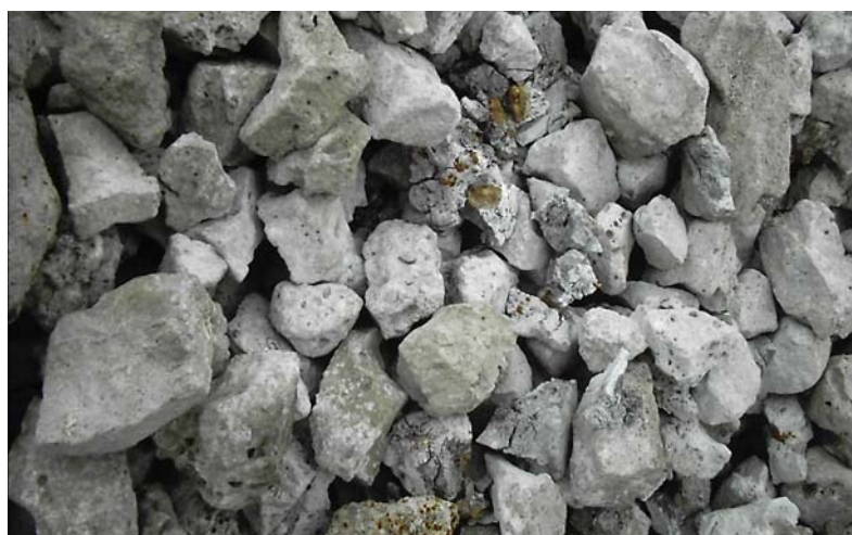
Figura 5.3 – Escórias fragmentadas pela expansão dos óxido de magnésio (cor alaranjada) no pátio de estocagem da Sobremetal em Ipatinga.
