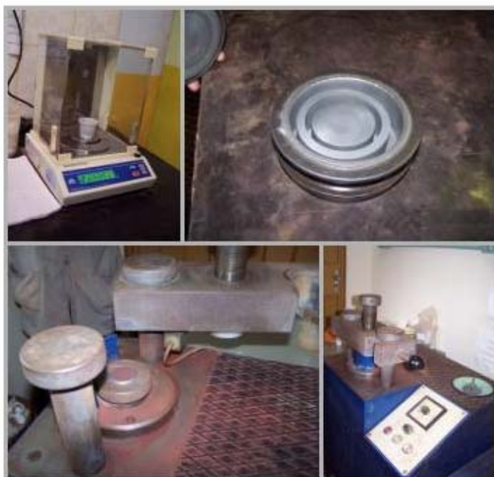
Figura 3.5 – Procedimentos de preparação das amostras nos ensaios de fluorescência de raios - X.
