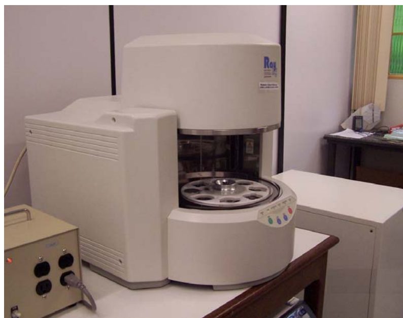
Figura 3.4 – Espectrômetro de Raios-X utilizado nos ensaios.
