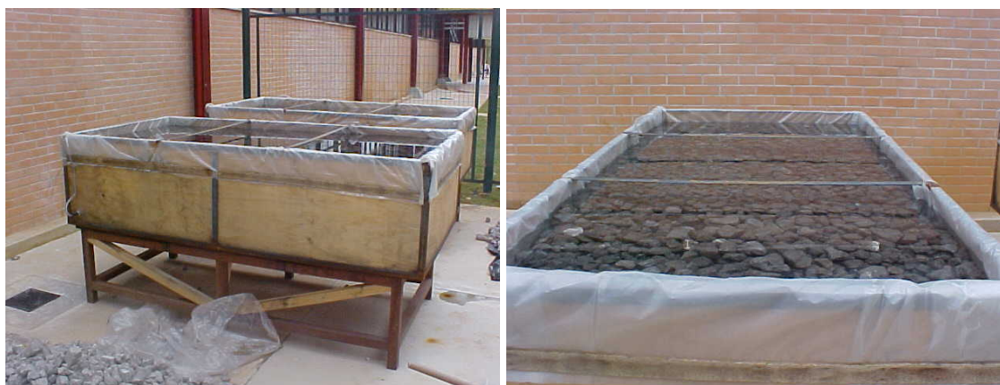
Figura 3.23 – Caixa-teste para avaliação dos efeitos da cura nas escórias de aciaria.
