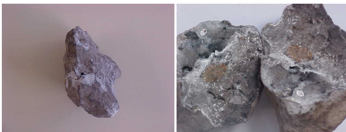
Figura 4.9 – Partícula ME1 utilizada no ensaio (fissurada e posterior ruptura, sendo o material esbranquiçado o sal da solução utilizada no ensaio).
