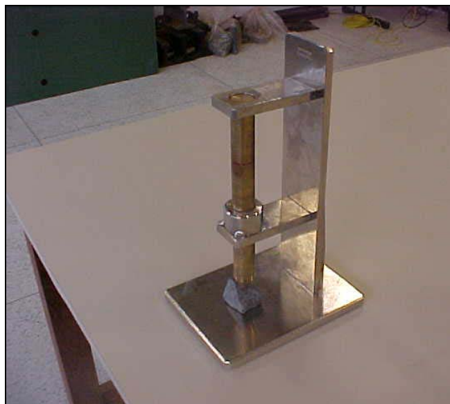
Figura 3.11 – Aparelho para a determinação do teor de material macio e friável.
