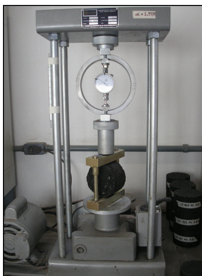
Figura 3.21 – Prensa mecânica utilizada para a realização dos ensaios de resistência a tração
