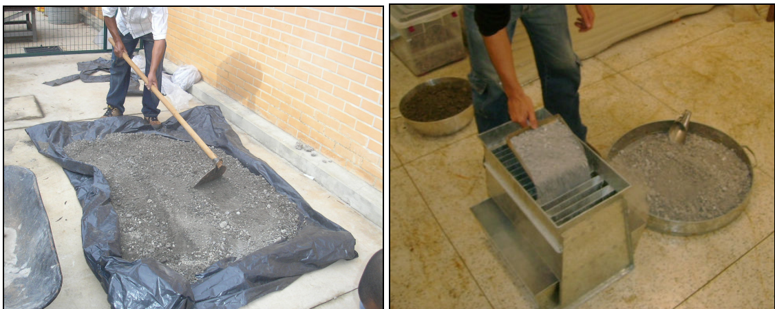
Figura 3.10 – Homogeneização e redução da amostra de campo de escória para o laboratório
