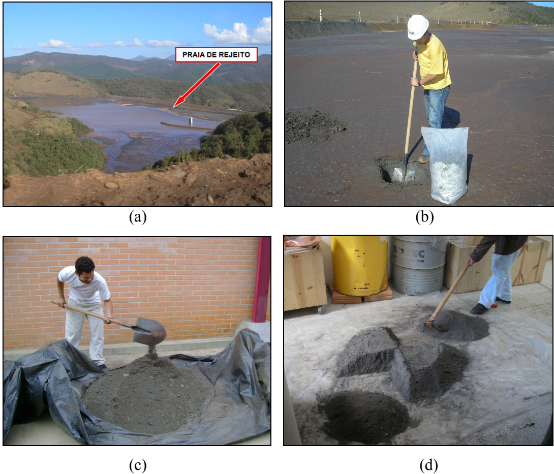
Figura 3.3 – Obtenção e homogeneização do resíduo: (a) barragem de rejeito; (b) coleta de amostras de rejeito de minério de ferro; (c) homogeneização do rejeito; (d) redução das amostras de campo por quarteamento.
