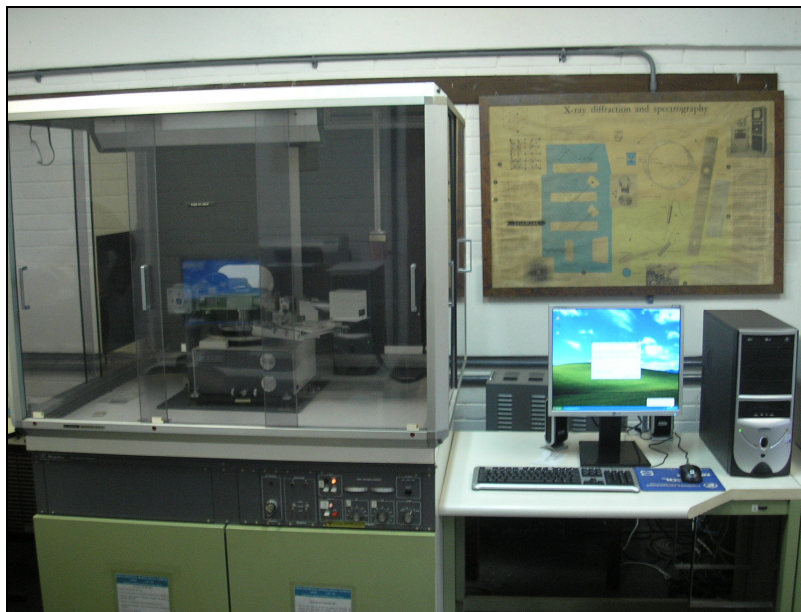
Figura 3.1 – Equipamento para análise difratométrica dos agregados
