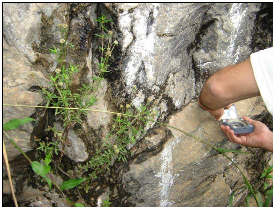
Figura 3.3 – Uso de bússola equipada com clinômetro do tipo Clar para o levantamento das principais atitudes das discontinuidades dos maciços rochosos.
