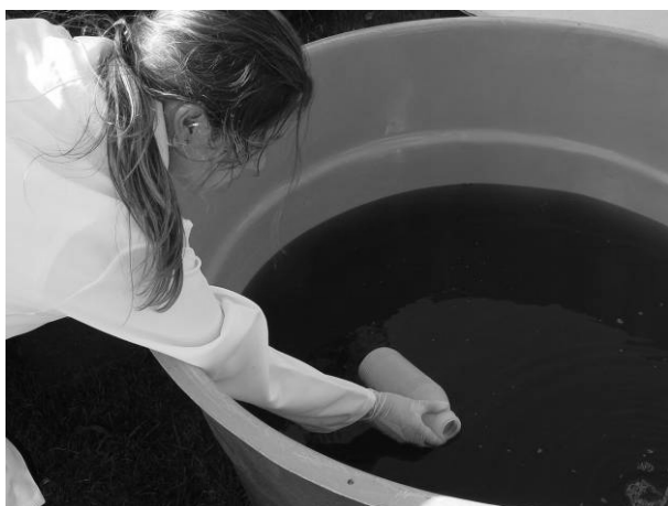
Figura 4.8 – Procedimento de coleta amostra do efluente decantado
