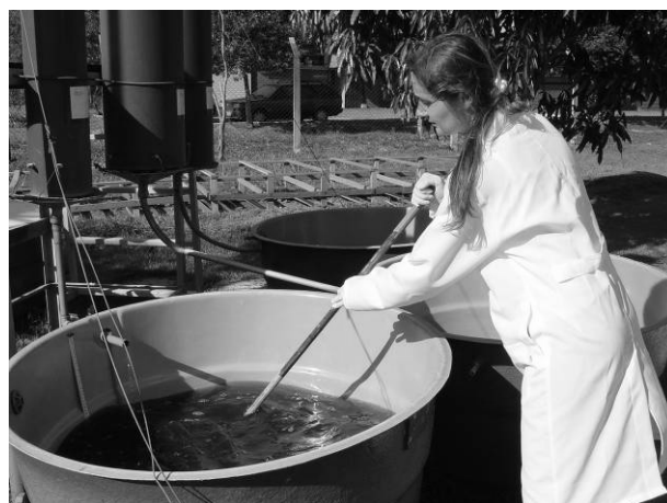
Figura 4.9 – Procedimento de coleta amostra do efluente não decantado
