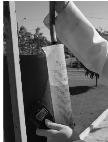
Figura 4.13 – Medição de vazão
