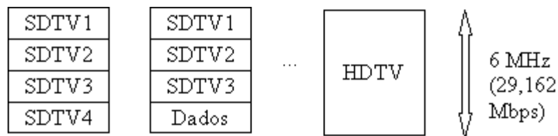
Figura A.6: Algumas opções de distribuição da largura de banda para TV digital
