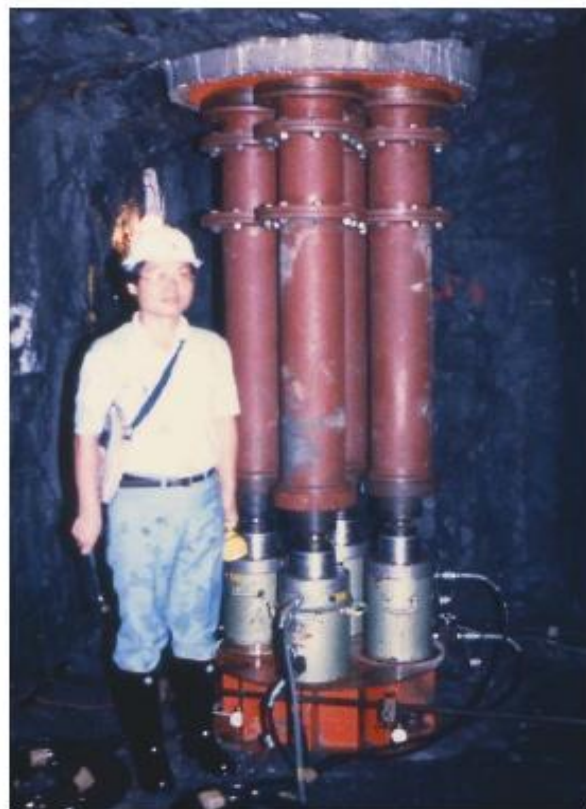
Figura 26 - Ensaio de E com macaco hidráulico in situ um projeto hidrelétrico em Taiwan (Hoek & Diederichs, 2006).
