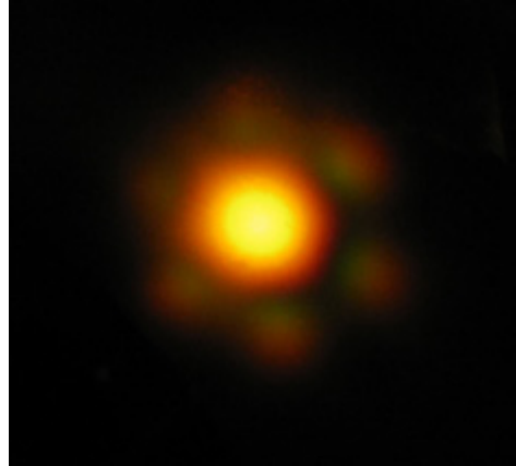
Figura 46 - Foto do supercontínuo gerado na fibra Nonlinear Photonic Fiber – SC-5.0-1040. Com a energia e a largura temporal do bombeio dados respectivamente por 1,6 \mu J e 54 ps.
