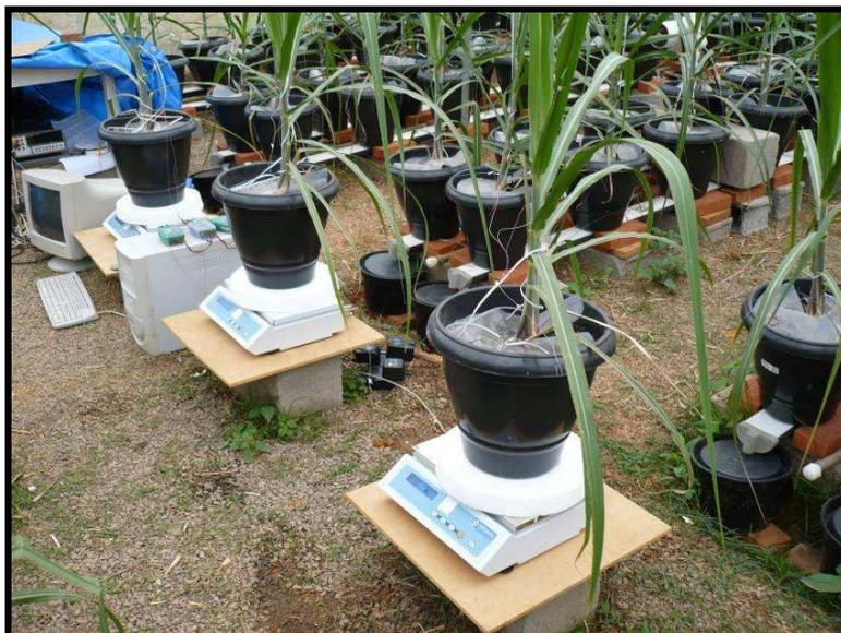
Figura 6 – Sistemas individuais de pesagem para medição da transpiração de plantas de cana-de-açúcar.
