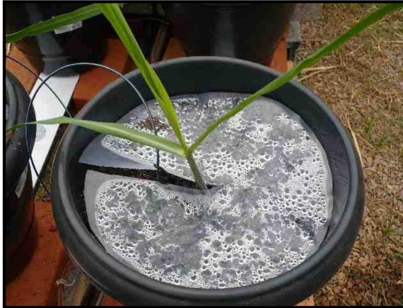
Figura 4 – Detalhe do micro-tubo do sistema de irrigação e da cobertura da superfície do substrato para minimizar a evaporação d'água.
