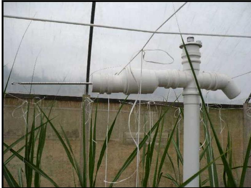
Figura 5 – Vista parcial do tubo de PVC aspirado onde foi instalado internamente o sensor de temperatura e umidade relativa do ar. Na parte externa foram fixados o piranômetro e o anemômetro de fio quente.
