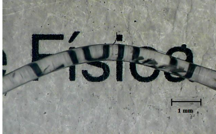
Figura 45 - Fotografia da fibra de \text{La}_2\text{O}_3 após flexão.
