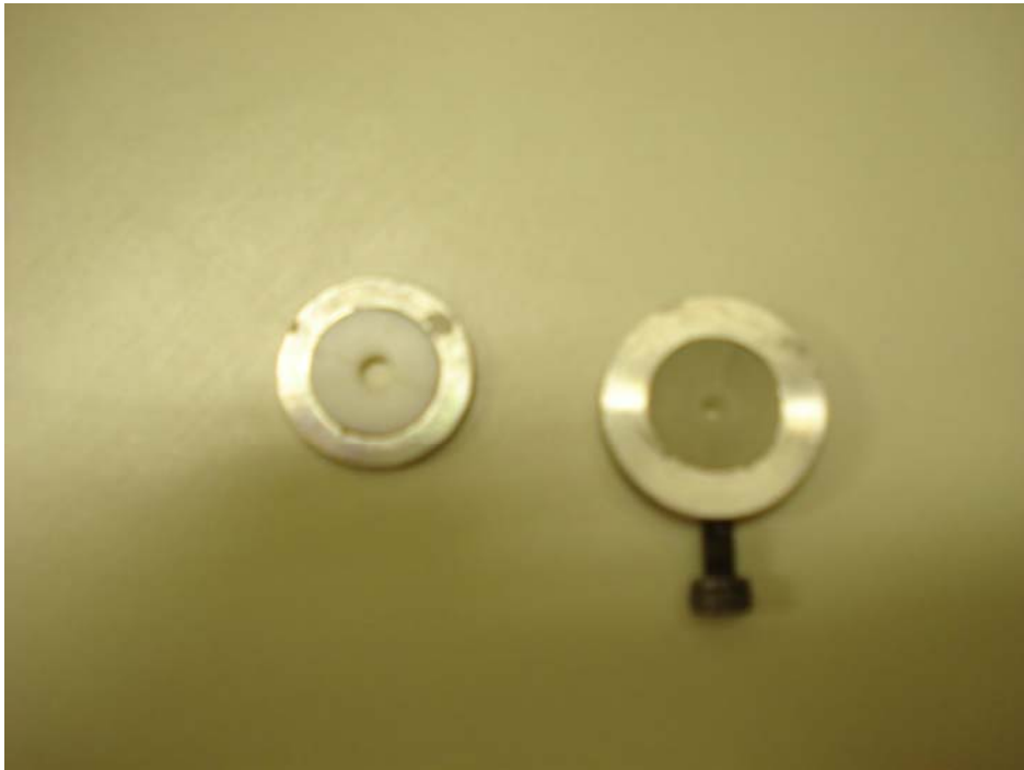
Figura 5 – Matriz para confecção de corpos de prova para o teste de resistência à compressão
