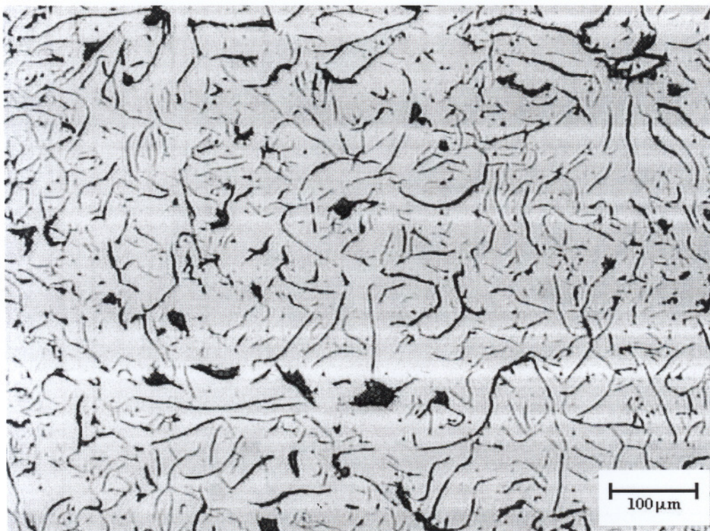
Figura 31. Foto micrografia da liga D sem ataque. Pode se observar veios de grafita do tipo 7 e tamanho 4, segundo a norma ASTM247-1990
