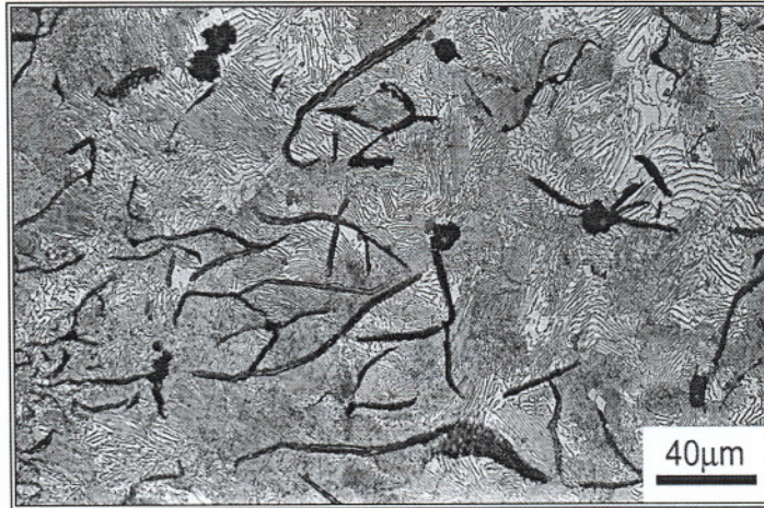
Figura 5. Ferro fundido cinzento com os veios de grafita em matriz perlítica. Ataque: Nital 2%. (Milan et al 2004)
