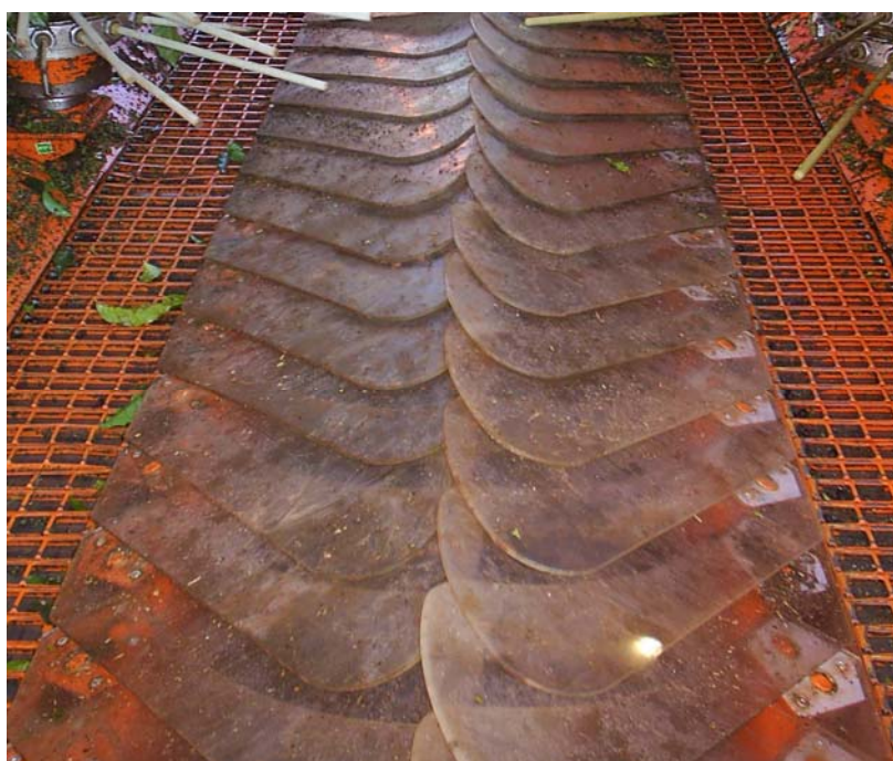
FIGURA 3 Conjunto de lâminas do recolhedor e grades do transportador horizontal.
