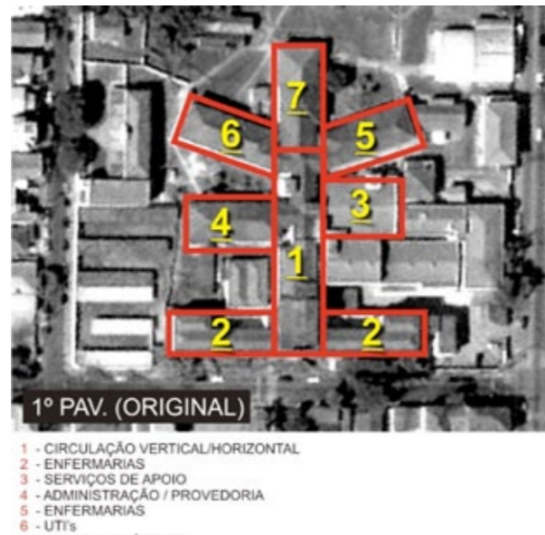
Fig. 43 Croqui esquemático da distribuição do primeiro pavimento original as Santa Casa Dona Carolina Malheiros.
