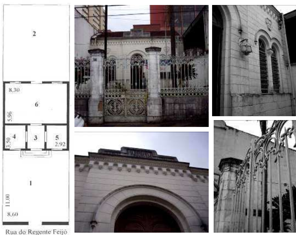
Figura 22: Planta da Escola, com recuo frontal (1) e posterior (2), vestíbulo (3), locutório (4), vestiário (5) e sala de aula (6). Imagens: fachada da escola e detalhe das aberturas 163
