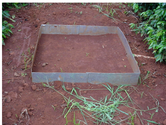
FIGURA 5 Dique de metal para coleta do escoamento superficial
