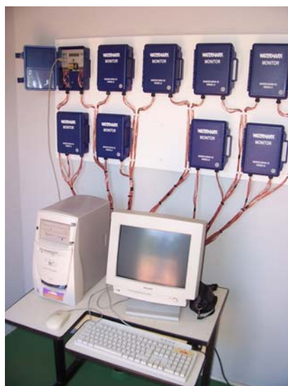
FIGURA 6 Dataloggers e microcomputador utilizados para registro e coleta de dados de tensão de água no solo.
