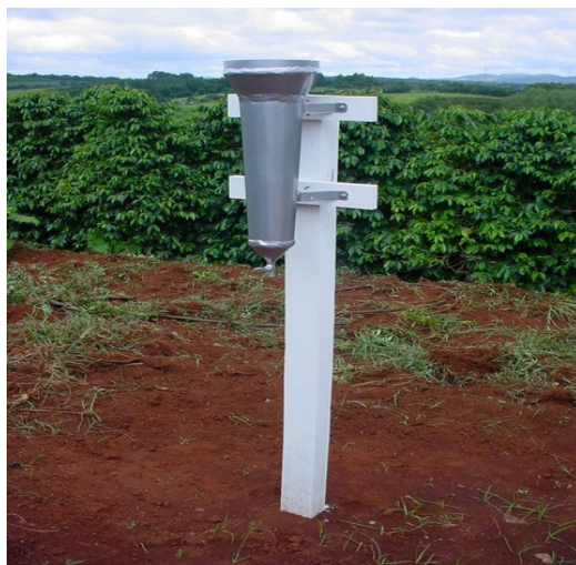
FIGURA 4 Vista geral do pluviômetro instalado na área experimental
