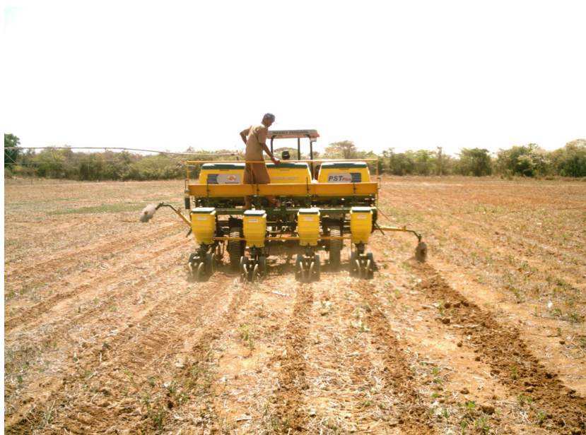
FIGURA 5 - Semeadora adubadora PST Plus ® da marca Machesan utilizada para o plantio do sorgo Fonte: Arquivo do autor.
