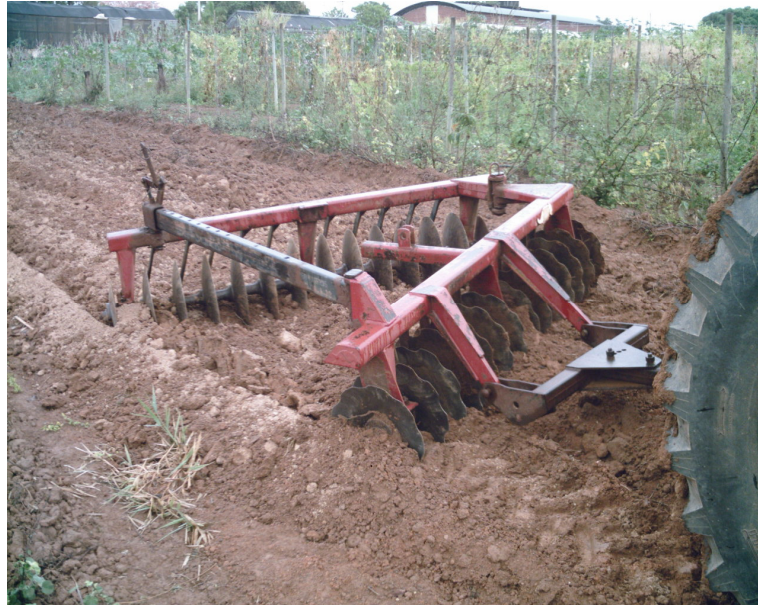
FIGURA 4 - Grade niveladora Machesan® de 28 discos Fonte: Arquivo do autor.
