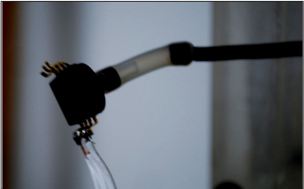
FIGURA 4.8 – Detalhe do Dispositivo Transdutor de Pressão.
