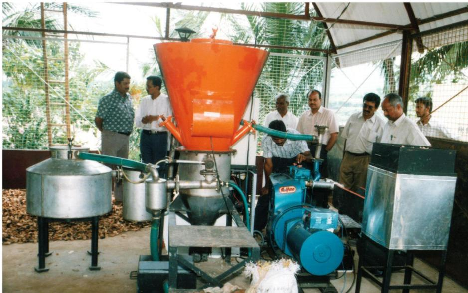
FIGURA 2.5 – GASEIFICADOR TIPO DOWNDRAFT
