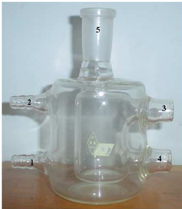
Figura 3.2 Foto da célula utilizada para obtenção dos dados experimentais [(1,2), junções de entrada e saída de Água; (3,4), pontos de amostragem; 5, posição de introdução de rolha de vedação e suporte para fixar os termopares].
