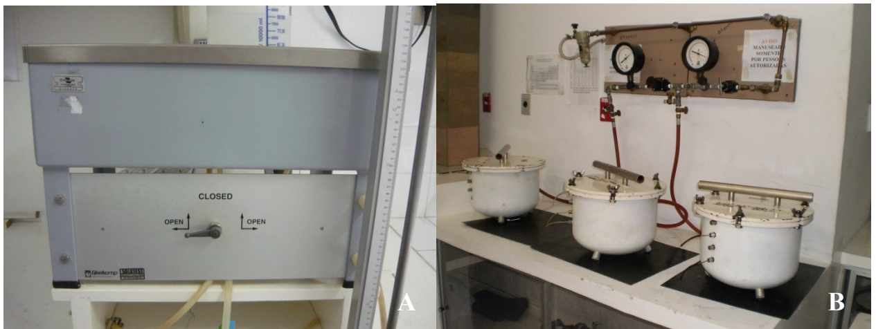
Figura 5. A) Mesa de tensão utilizada para baixas tensões. B) Extrator de Richards utilizado para médias e altas tensões
