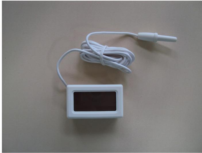
Figura 3.2 - Sensor de temperatura digital
