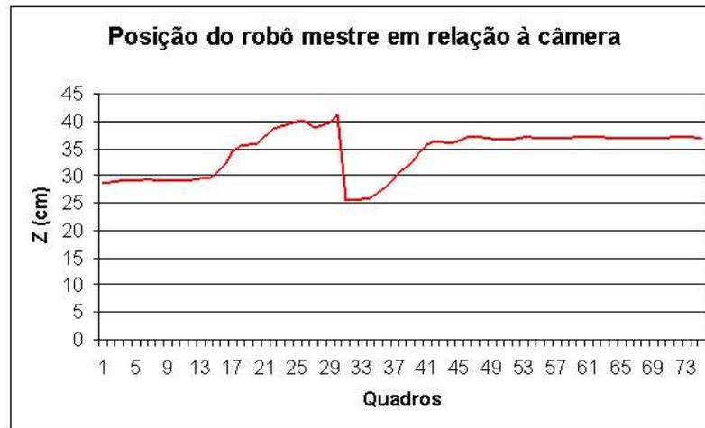
Figura 5.13: Posição  $z$  do robô mestre em relação à câmera
