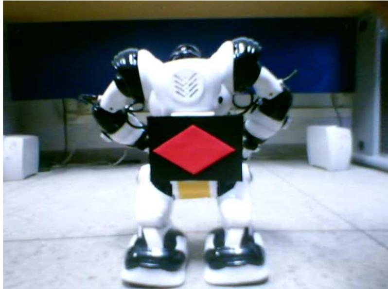
Figura 4.4: Marca utilizada para estimação de pose do robô humanóide
