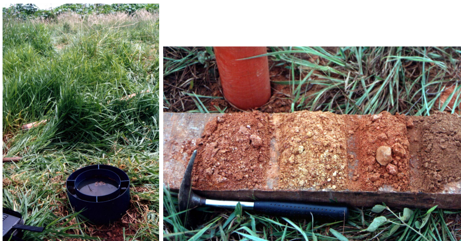
Figura 26 – Ensaio Duplo Anel (esquerda – observar mamonas ao fundo, indicando depósitos antigos de resíduos sólidos) e Open End , com amostragem do solo (da direita para a esquerda: superfície; 0,5 m; 1,0 m e 1,19 metros.) – porção Centro-Oeste da área.
