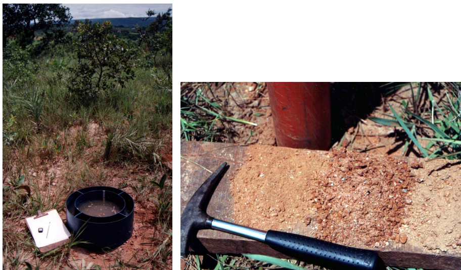
Figura 28 - Ensaio de Duplo Anel (esquerda) e Open End , com amostragem do solo (da direita para a esquerda: superfície; 0,5 m; 0,77 m) – porção Sudeste da área.
