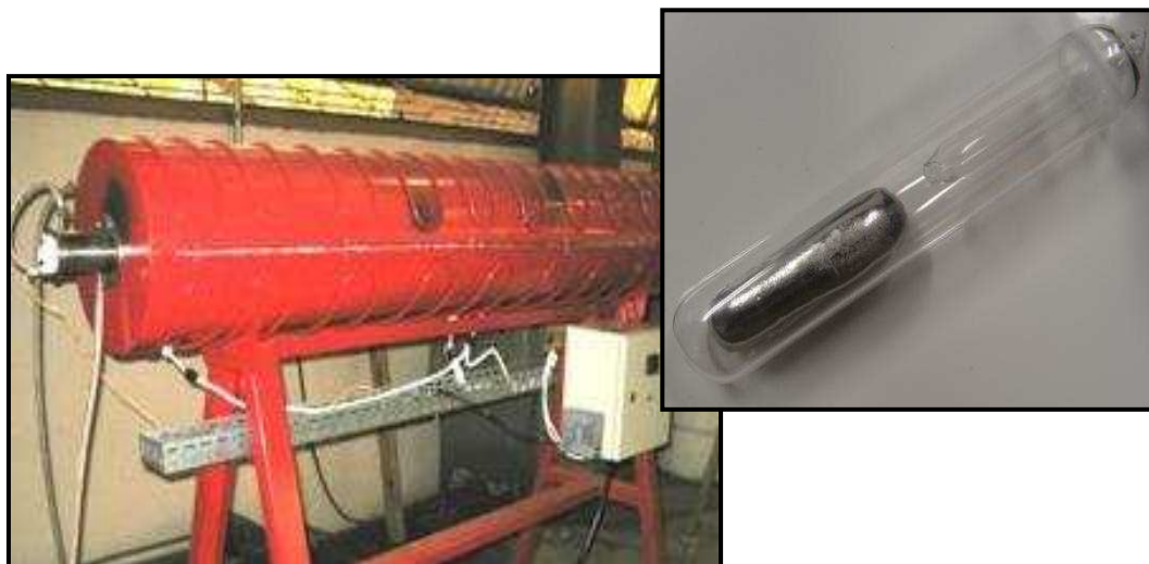
Figura 3.3 - Forno tubular empregado para homogeneização das ligas. Detalhe do lingote encapsulado a vácuo
