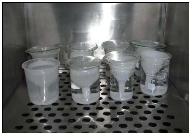
Figura 3.9 - Detalhe das amostras imersas em SBF utilizando funil para homogeneização do depósito da apatita
