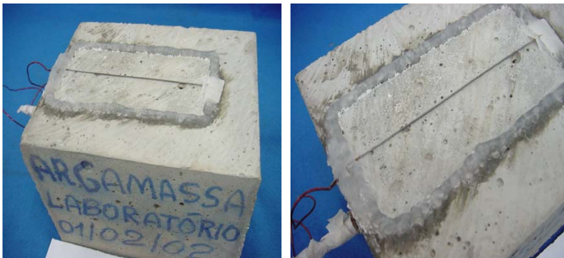
Fotografia 6.16 – Detalhes do ensaio de durabilidade das argamassas
