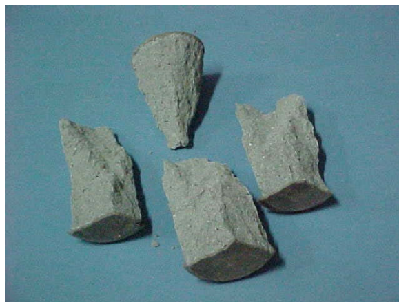
Fotografia 6.4 - Registro dos cp s 5 cm x 10 cm antes e depois de serem rompidos à compressão axial.
