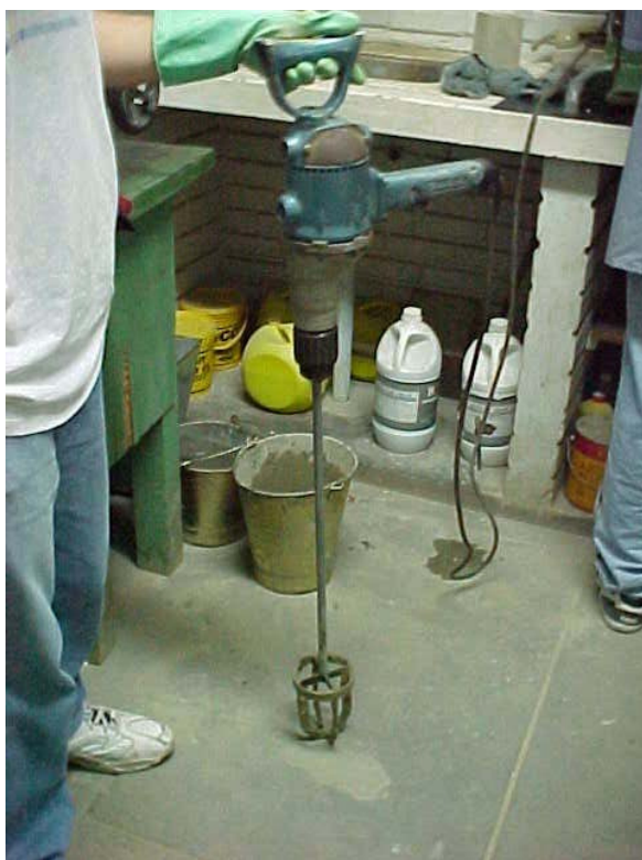
Fotografia 6.1 – Equipamento utilizado na mistura e local de armazenamento das argamassas.
