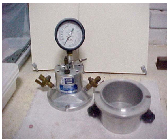
Fotografia 6.3 – Aparelho para obtenção do volume de ar incorporado na argamassa.
