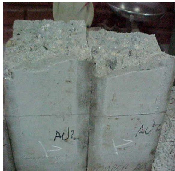
Fotografia 6.11 – Verificação do deslocamento da argamassa após a ruptura.
