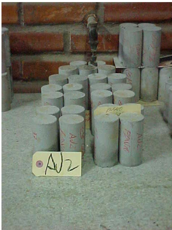
Fotografia 6.4 - Registro dos cp s 5 cm x 10 cm antes e depois de serem rompidos à compressão axial.
