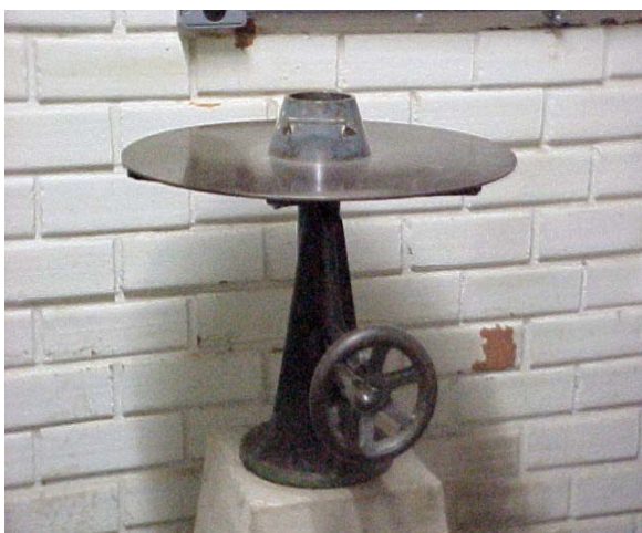
Fotografia 6.2 – Mesa para obtenção do índice de consistência
