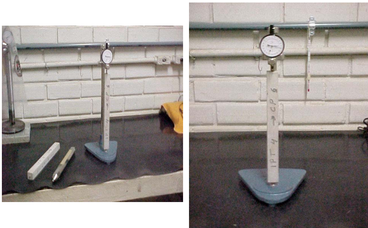
Fotografia 6.9 – Aparelho usado na determinação da retração livre.
