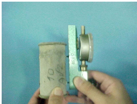
Fotografia 6.6 – Exemplifica a ação de encaixe e posterior medida da deformação.
