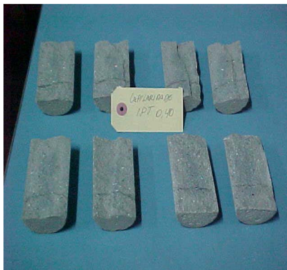
Fotografia 6.8 – Corpos-de-prova rompidos à tração por compressão diametral, visando à verificação da altura capilar.
