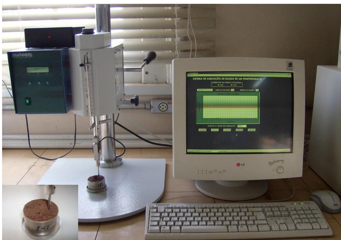
Figura 3.3 - Penetrômetro eletrônico de bancada para a determinação da resistência mecânica do solo à penetração.
