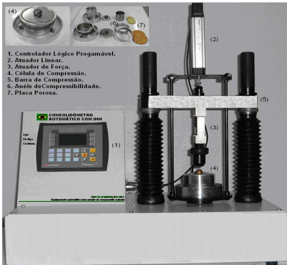
Figura 4.3 - Consolidômetro automático utilizado na determinação dos parâmetros compressivos.
