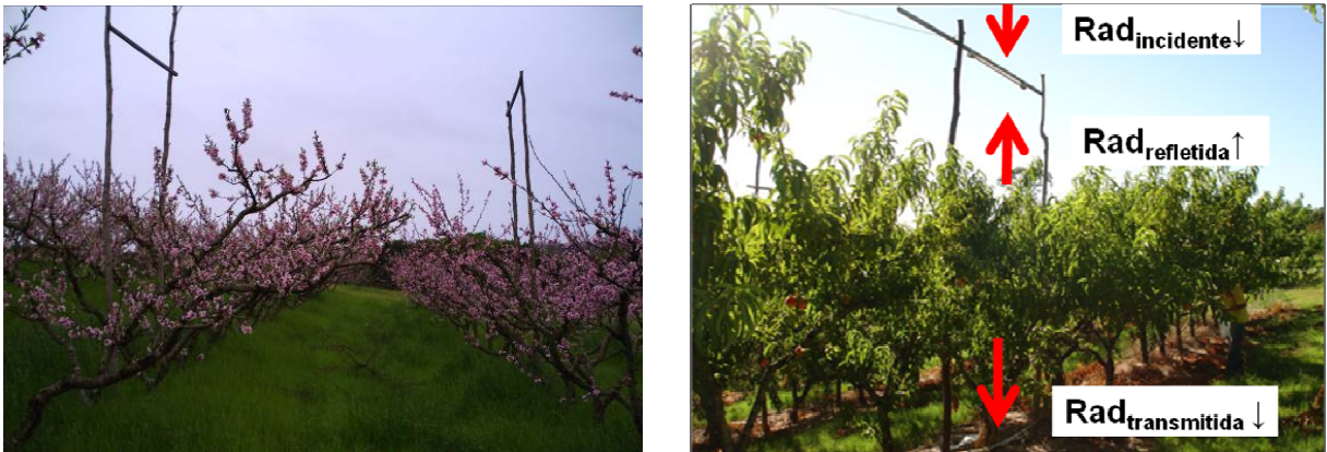
Figura 01- Estrutura instalada para avaliação da incidência, transmissão e reflexão da radiação solar global em ( W m^{-2} ) em pomar de pessegueiro. FAEM/UFPel, Pelotas-RS, 2010.
