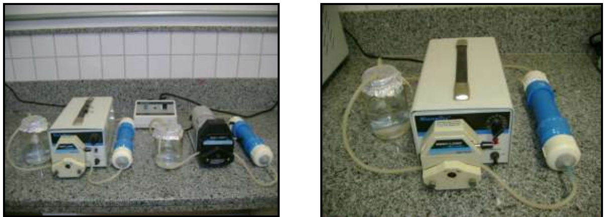
Figura 2 - Sistema experimental para formação do biofilme de P. fluorescens em meio mínimo de sais, por cinco dias consecutivos, a 25 °C.
