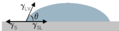
Figura 1 - Ângulo de contato ( \theta ) entre uma gota de líquido e uma superfície plana e horizontal. As tensões superficiais da superfície do sólido \gamma_S , do líquido em equilíbrio com o vapor \gamma_{LV} e superfície/líquido \gamma_{SL} (van LOOSDRECHT et al., 1987).
