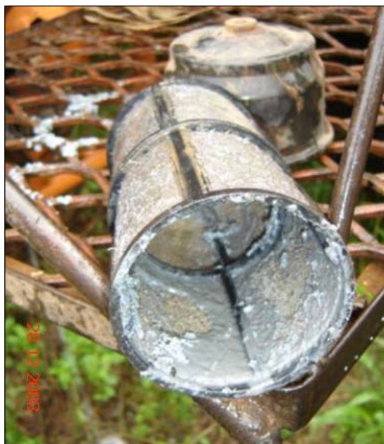
FIGURA 10. Filtro de pulverizador com depósito de resíduos durante a aplicação de calda bordalesa. Butiá, RS, 2007.
