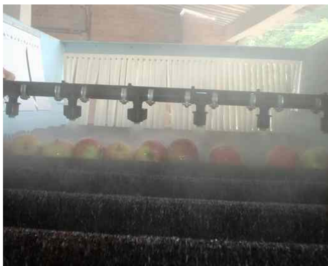
FIGURA 25. Detalhe da barra com os bicos de aspersão de água do tipo leque (Marca Jacto, mod. 110-SF-015), Porto Alegre, RS, 2006.
