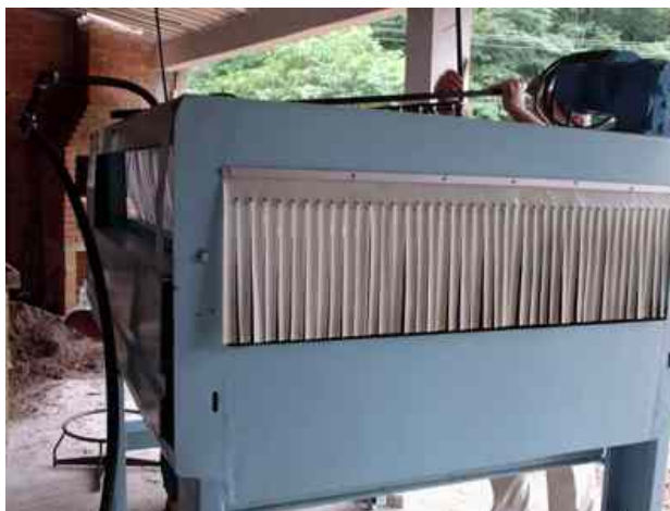
FIGURA 24. Detalhe do equipamento para aspersão da água, acoplado a máquina classificadora de frutos, Porto Alegre, 2006.
