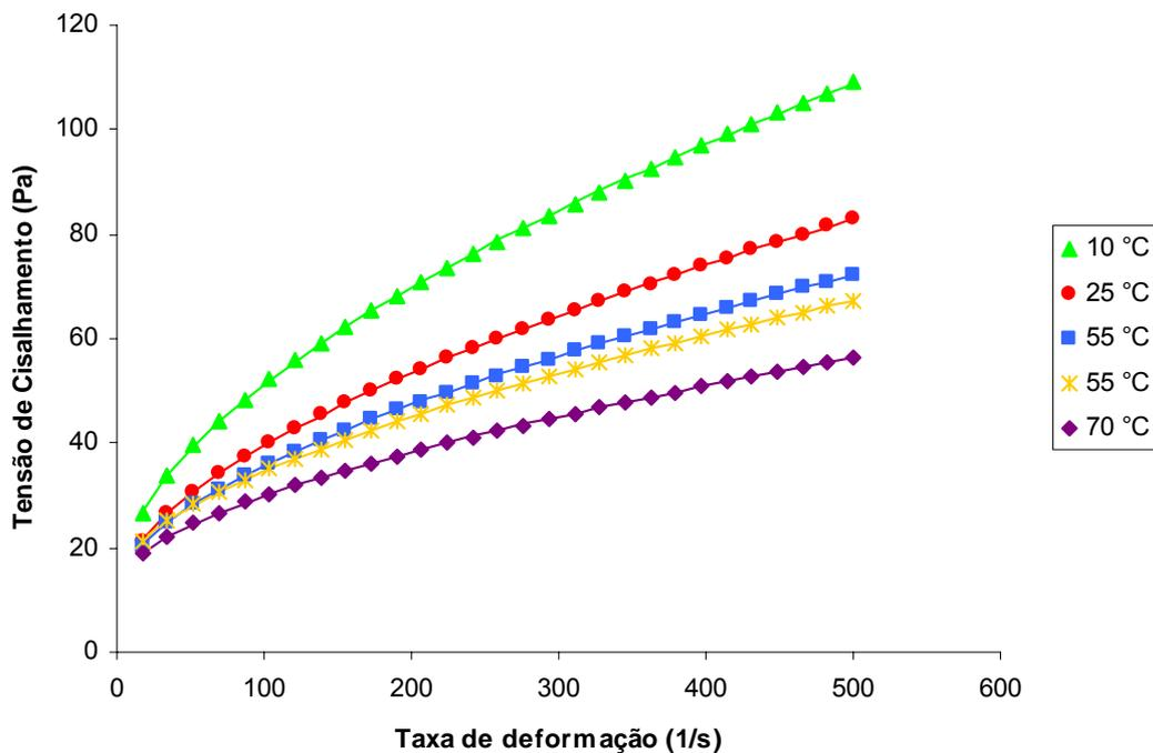
Figura 18- Relação entre a tensão de cisalhamento e a taxa de deformação descrita pelo modelo de Herschel-Bulkley para a polpa de manga Ubá a 20 °Brix em diferentes temperaturas.
