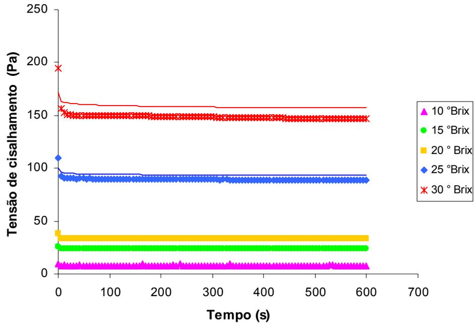
Figura 12- Relação entre tensão de cisalhamento e tempo à taxa de deformação constante de  $30 \text{ s}^{-1}$  com ajuste pelo modelo de Weltman para diferentes concentrações de polpa de manga Ubá a temperatura de  $10 \text{ }^\circ\text{C}$ .
