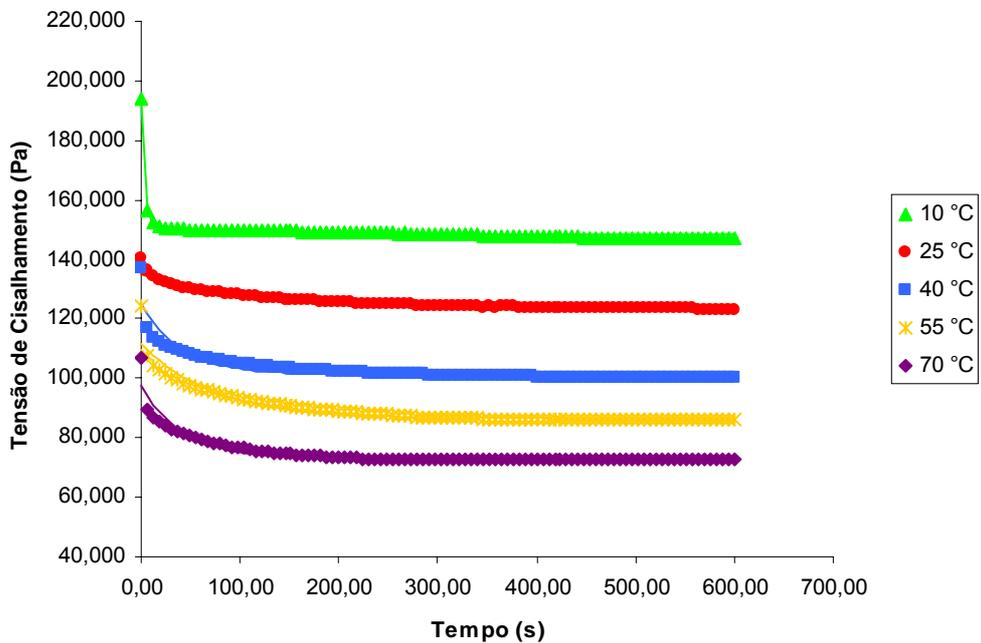
Figura 15- Relação entre tensão de cisalhamento e tempo à taxa de deformação constante de  $30 \text{ s}^{-1}$  com ajuste pelo modelo de Figoni e Shoemaker para diferentes temperaturas de polpa de manga Ubá com concentração de 30 °Brix.
