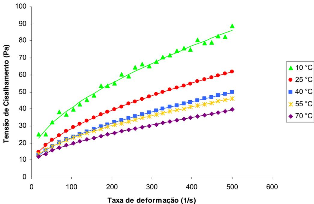
Figura 17- Relação entre a tensão de cisalhamento e a taxa de deformação descrita pelo modelo de Herschel-Bulkley para a polpa de manga Ubá a 15 °Brix em diferentes temperaturas.
