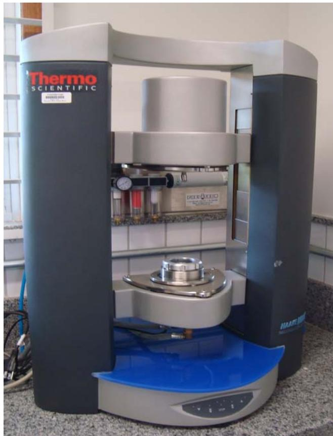
Figura 7 - Reômetro rotativo da marca HAAKE, modelo Modular Advanced Rheo Svstem
