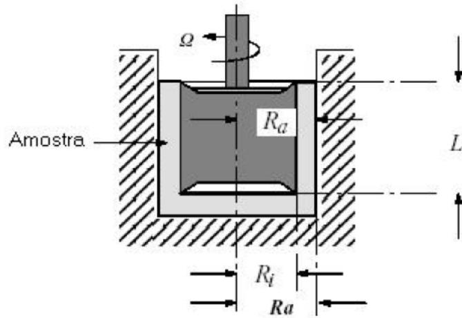
Onde:  $\Omega$  = velocidade do rotor,  $R_a$  = raio do rotor,  $R_i$  = raio do cilindro de medida e  $L$  = altura do rotor.
