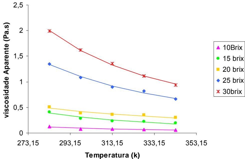
Figura 21- Efeito da temperatura sobre a viscosidade aparente da polpa de manga Ubá a diferentes concentrações de sólidos solúveis.
