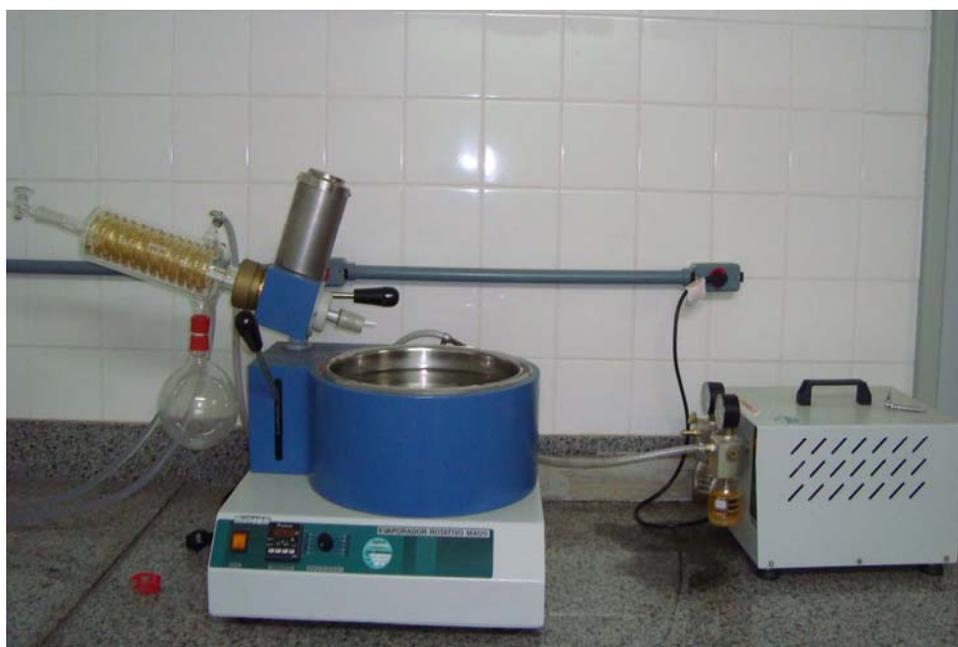
Figura 5- Evaporador rotativo à vácuo vertical. (Laboratório de Processamento de Frutas e Hortaliças – Dep. de Engenharia de Alimentos, UFV)
