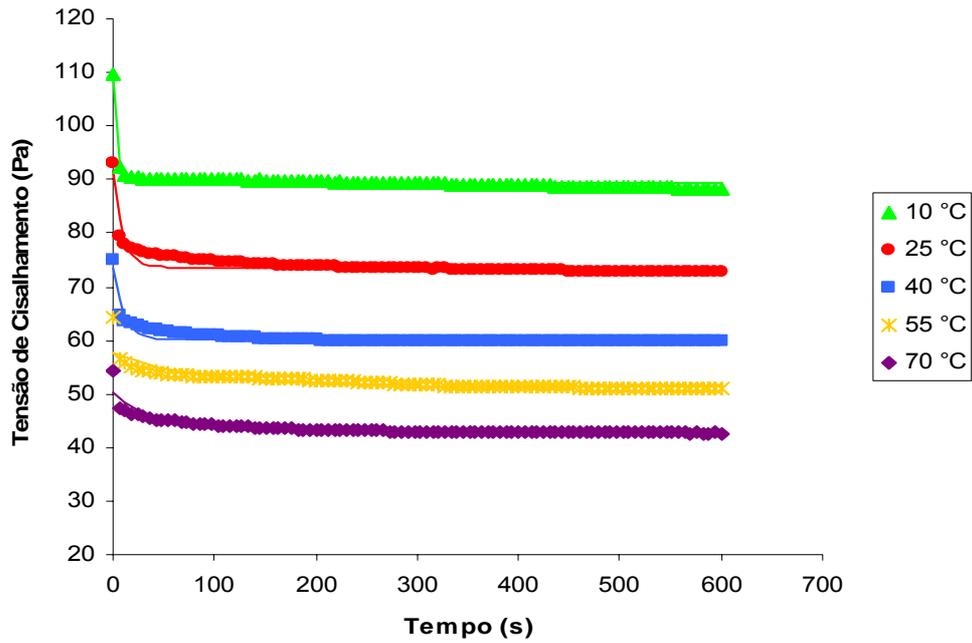
Figura 14- Relação entre tensão de cisalhamento e tempo à taxa de deformação constante de  $30 \text{ s}^{-1}$  com ajuste pelo modelo de Figoni & Shoemaker para diferentes temperaturas de polpa de manga Ubá com concentração de 25 °Brix.
