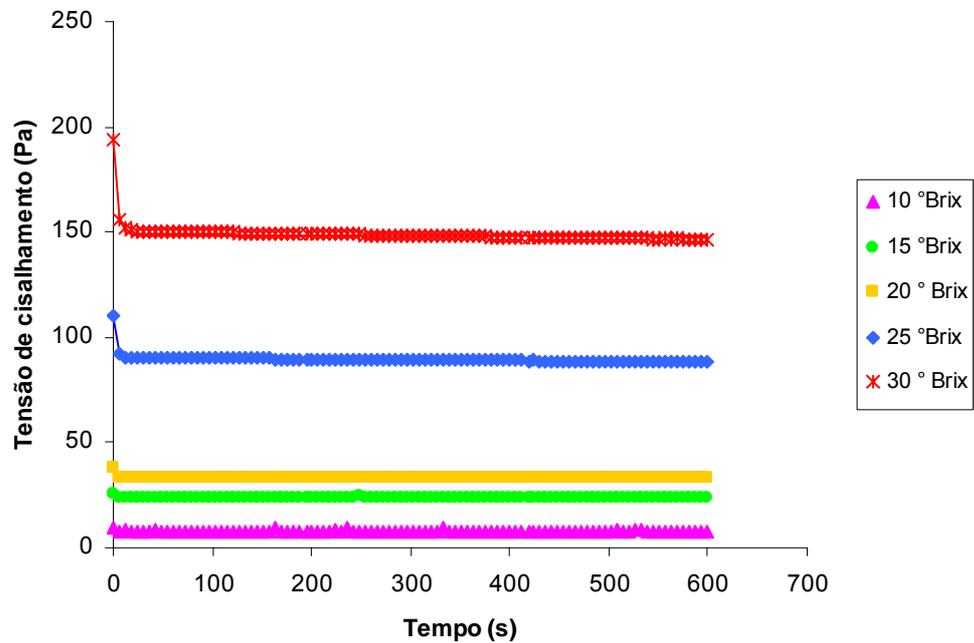
Figura 13- Relação entre tensão de cisalhamento e tempo à taxa de deformação constante de  $30 \text{ s}^{-1}$  com ajuste pelo modelo de Fignoni & Shoemaker para diferentes concentrações de polpa de manga Ubá a temperatura de  $10 \text{ }^\circ\text{C}$ .
