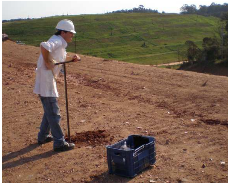
FIGURA 4.8 – COLETA DE AMOSTRAS DE SOLO COM O AUXÍLIO DE TRADO MANUAL
