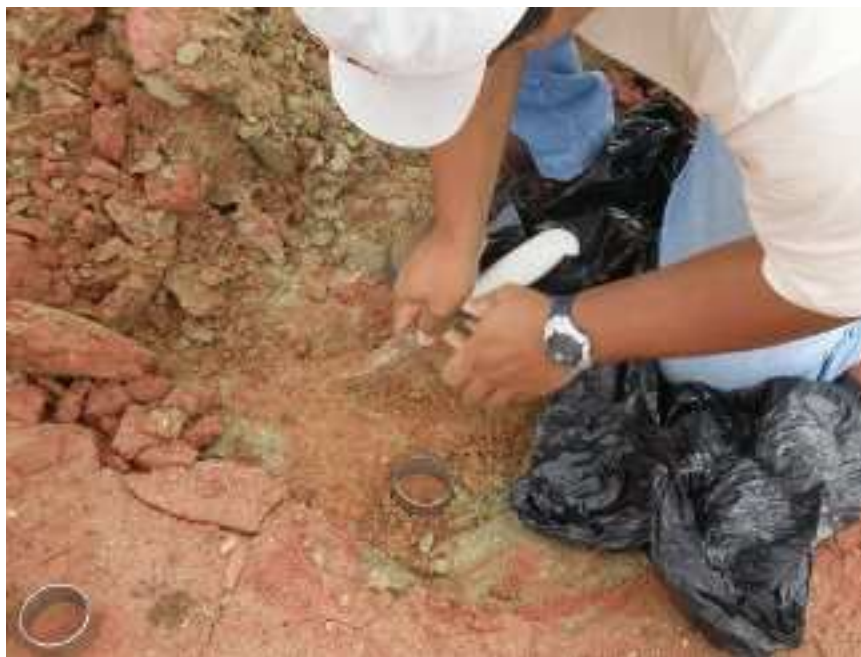
FIGURA 5.7 – CAMADA DE COBERTURA DE SOLO COM IRREGULARIDADES OBSERVADAS DURANTE A COLETA DE AMOSTRAS
