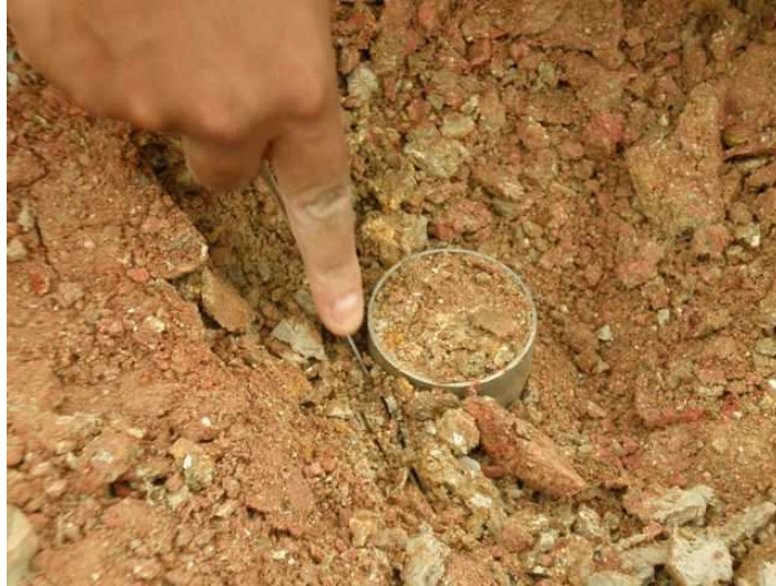
FIGURA 4.6 - COLETA DE AMOSTRAS DE SOLO PARA ENSAIOS DE RETENÇÃO DE UMIDADE
