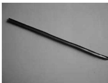
Perfil de chumbo para confecção de vitral coleção do autor
