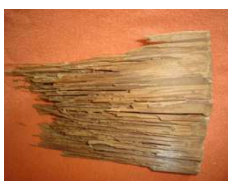
resultado de ataque em pinho de riga coleção do autor
