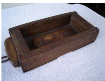
Forma de tijolo utilizada no século XIX observar a marca do empreiteiro ou mestre na parte interna – Coleção do autor
