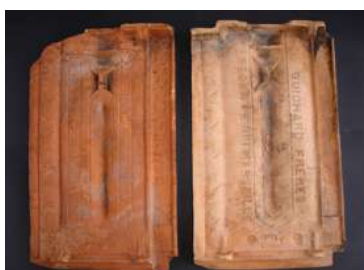
Telhas francesas ou de Marselle, a mais clara está bem porosa, tem provavelmente sua estanqueidade comprometida, será necessário algum tipo de impermeabilização por imersão – coleção do autor
