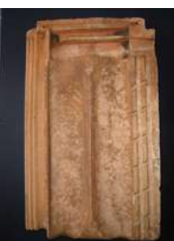
Telhas francesas ou de Marselle, a mais clara está bem porosa, tem provavelmente sua estanqueidade comprometida, será necessário algum tipo de impermeabilização por imersão – coleção do autor
